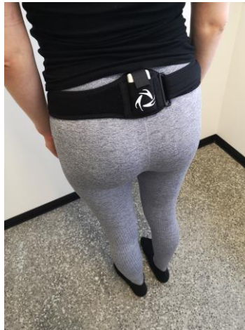
Kuva 1. G-Walk-sensorin asettelu (Kuva: Selja Haataja).
