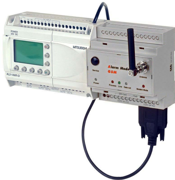
KUVA 6. Mitsubishi Alpha -logiikka varustettuna GSM modeemilla
