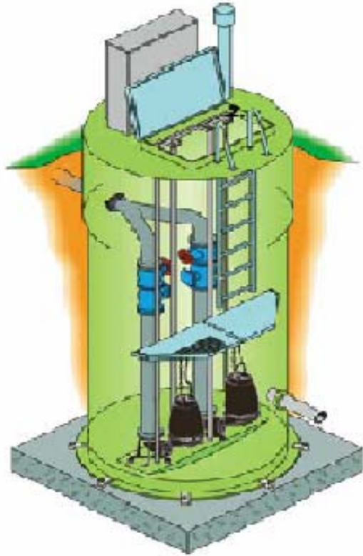
KUVA 1. Säiliöpumppaamo (Oy Grundfos Pumput Ab 2007)
