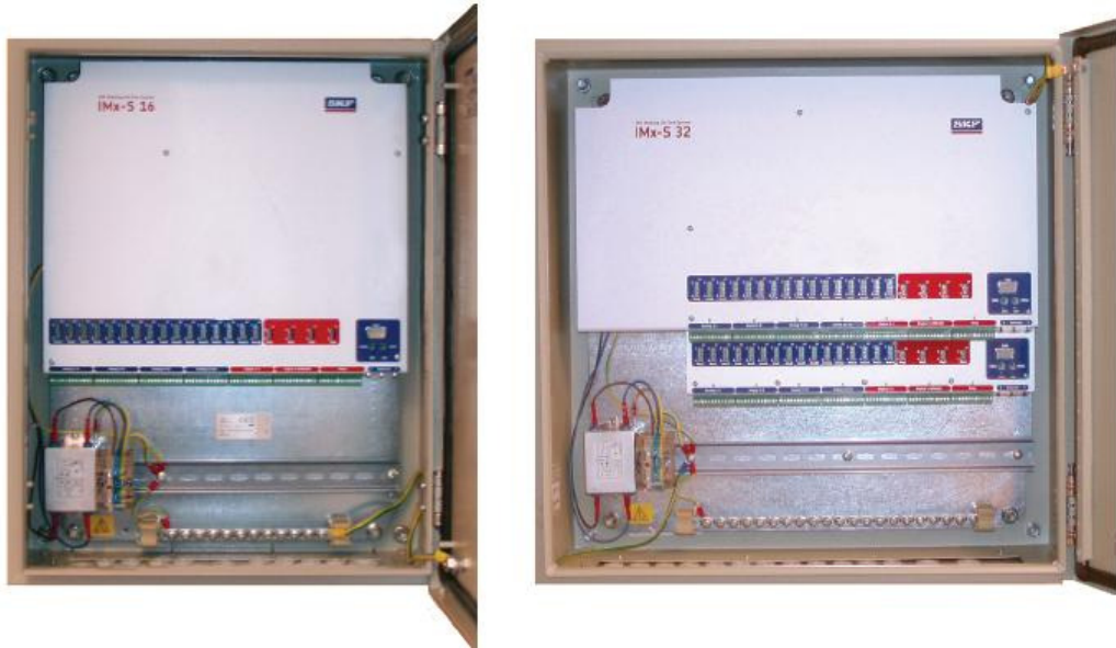
Kuva 8.14 IMx-S 16-kanavainen mittausyksikkö (vasemmalla) ja IMx-S 32-kanavainen mittausyksikkö (SKF 2011)
