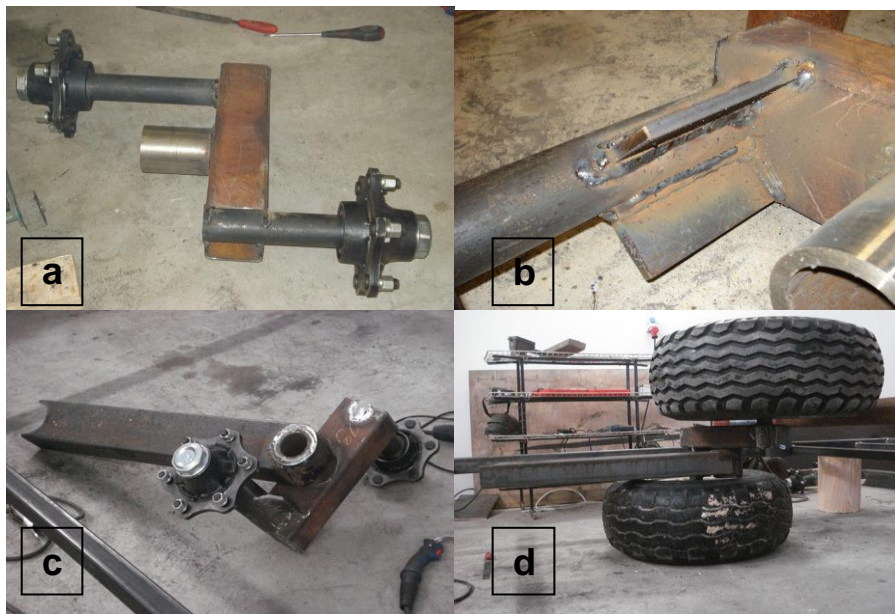
Kuva 6. Telin valmistus vaiheittain: a) Telivarteen hitsattuina pyörännavat ja nivelholkki b) Ulomaisen pyörännavan vahvistus lattaraudoin c) Telin nostovarren kiinnitys teliin d) Renkaat kiinnitettynä teliin.
