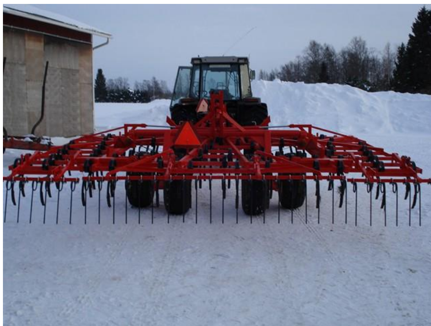
Kuva 10. Valmis äes työasentoon levitettyinä
