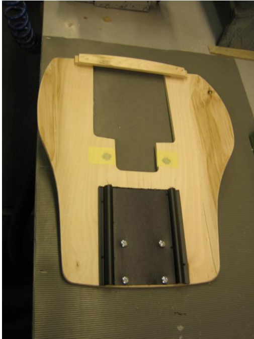
Kuva 5. Päämiehen toimittama puinen insertti johon on alihankkijan työpisteellä asennettu muovinen komponentti.
