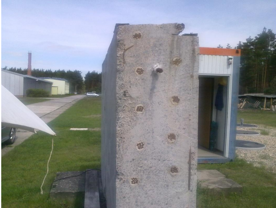
KUVA 4. Sillan jännepalkin pala BAM:n testausalueella
