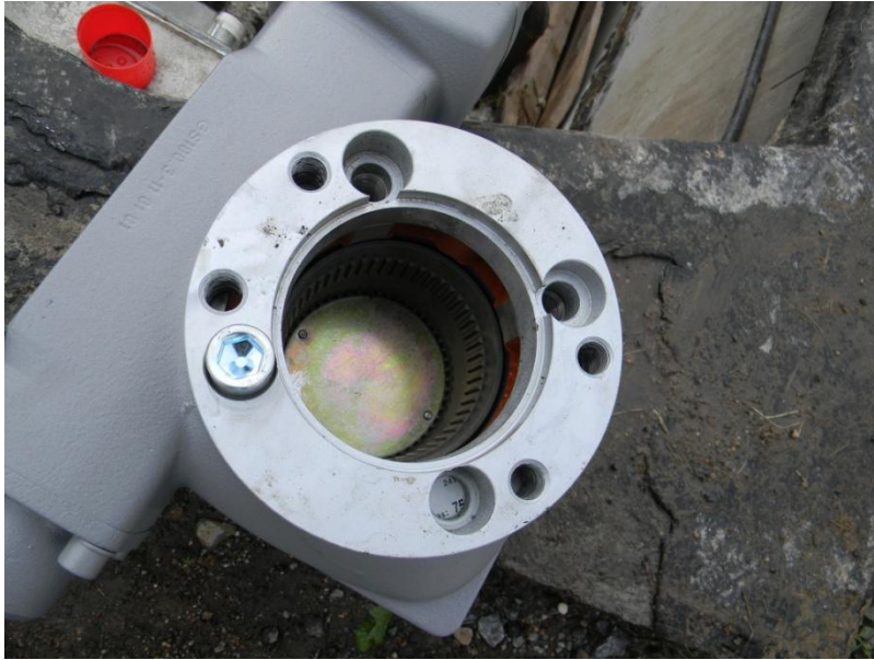
KUVA 17. Sovitekappaleen kiinnitys vaihteistoon
