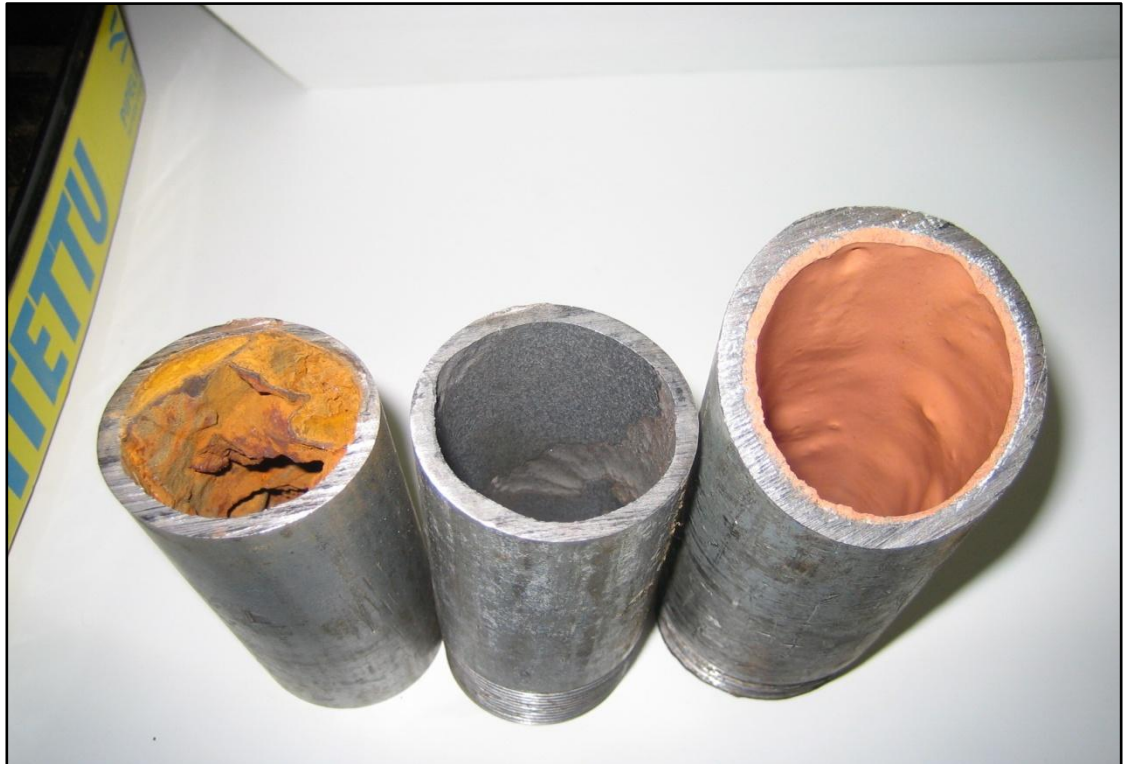
KUVA 15. Puhdistamaton, puhdistettu ja pinnoitettu putki /6/
