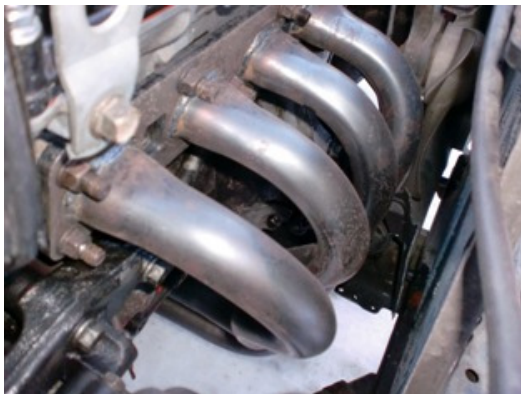
Kuva 9. Mazdaan tehty peltipakosarja 4-1
