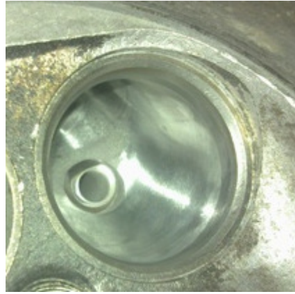
KUVA 4. Muokkaamaton imukanava KUVA 5. Muokattu imukanava venttiilinistukkarenkkaan kautta kuvattuna.
