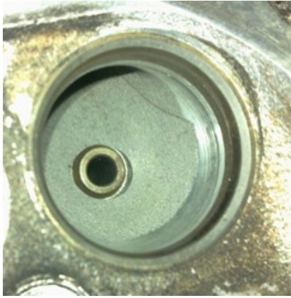
KUVA 4. Muokkaamaton imukanava KUVA 5. Muokattu imukanava venttiilinistukkarenkkaan kautta kuvattuna.
