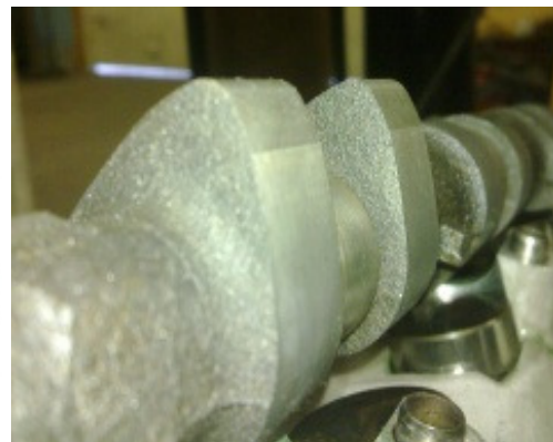
KUVA 7. Mazdan hiottu nokka-akseli
