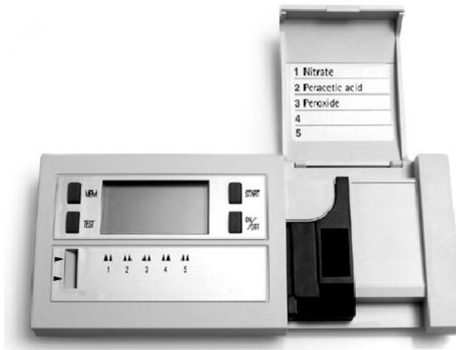
KUVIO 1. Reflektometri Merck Reflectometer RQflex 10 (RQflex 10 Manual, n.d. 28.)
