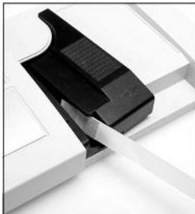
KUVIO 2. Määrittäysliuska laitetaan reflektometrin lukija osaan (RQflex 10 manual n.d. 16.)
