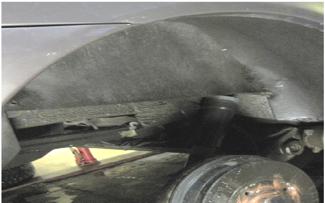
Kuva 4. 2002 Megane, jonka pyöränkoteloon on kiinnitetty bitumimattoa
