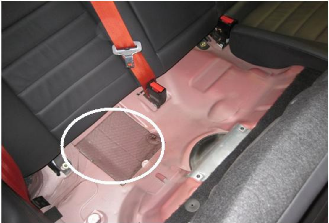
KUVA 3. Kuvasta on nähtävissä valmistajan laittaman vaimennusmateriaalin määrä.
