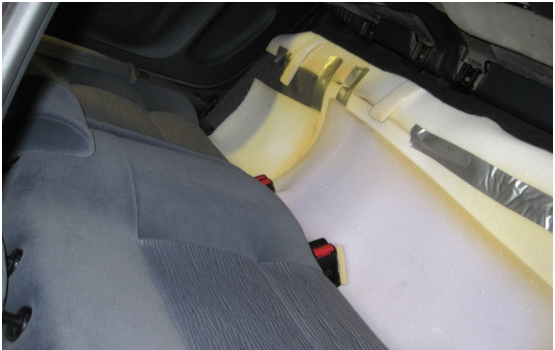
Kuva 5. 2002 Meganen takapenkkien alusen eristys toteutettuna vaahtomuovilla.
