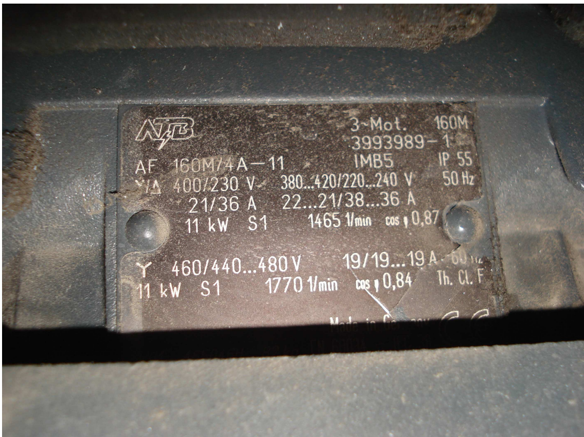
Kuva 5.6 Erään ruiskuvalukoneen 11 kW:n sähkömoottorin kilpiarvot
