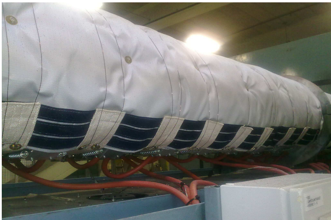
Kuva 5.3 Kuva eräästä ruiskutus sylinteristä, jossa on yhtenäinen lämpöeristysvaippa
