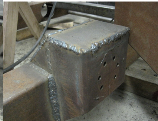
KUVA 4. Taimmaisen telapyörän kiinnitys
