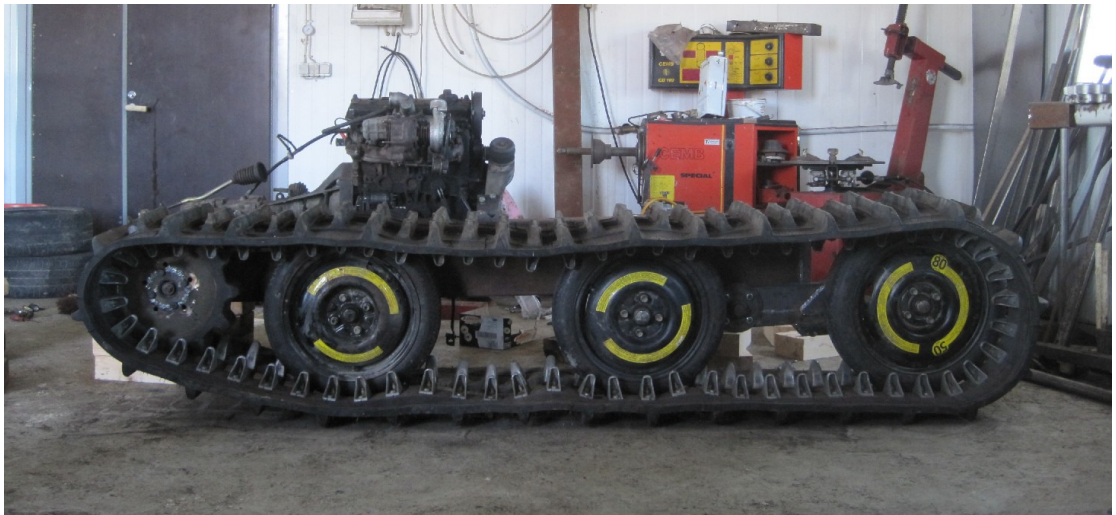
KUVA 10. Telasto paikalleen kasattuna
