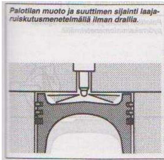
KUVA 4. Suoraruiskutus laajaruiskutusmenetelmällä (Bosch 2003, 419)
