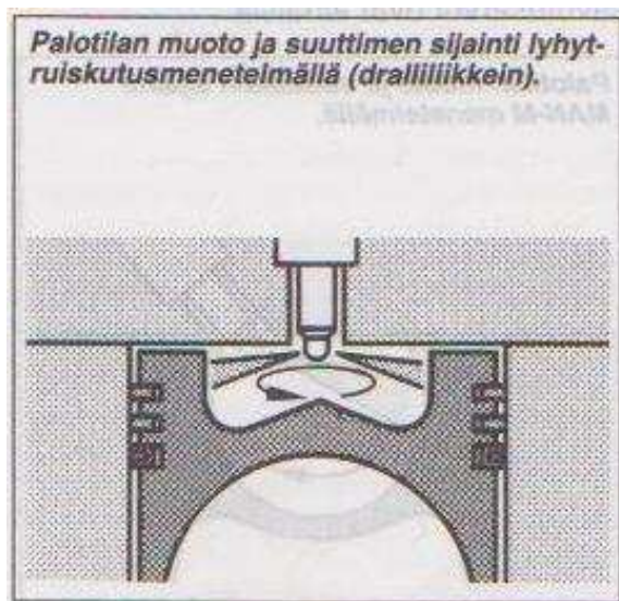
KUVA 5. Suoraruiskutus lyhytruiskutusmenetelmällä (Bosch 2003, 419)
