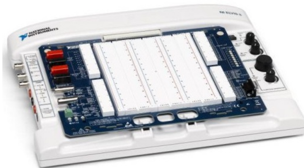
Kuvio 1: ELVIS II+ ja siihen liitetty kytkentäalusta
