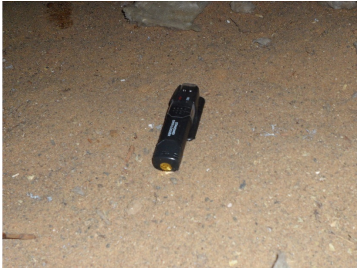
Bild 8. Mätare på mark i krypgrund.
