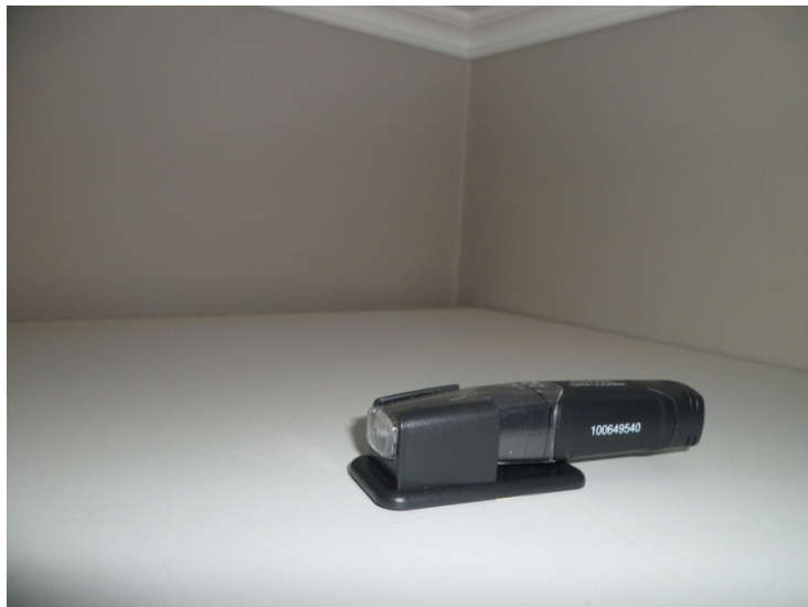
Bild 12. Mätare inomhus i hjälpköket. Mätaren placerad högt för att inte vara i vägen.
