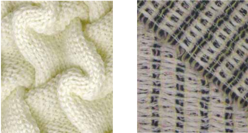
Kuva 7. Vasemmalla links-links- neulosrakenne, oikealla eri sidosten sovellus, kudottu kangas.
