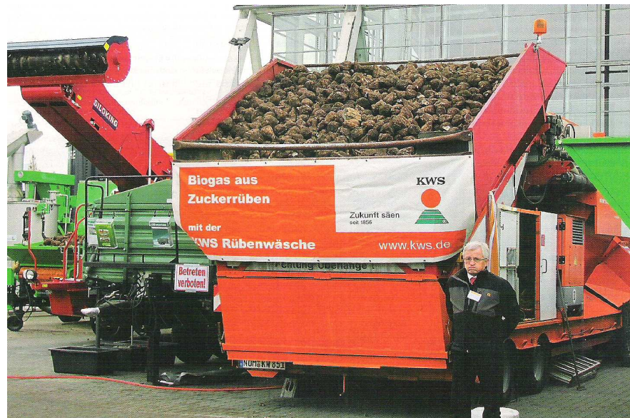
Kuva 8. Juurikaspesuri johon käsiteltävä materiaali lastataan kauhakuormaajalla. (Uotila 2010, 14.)
