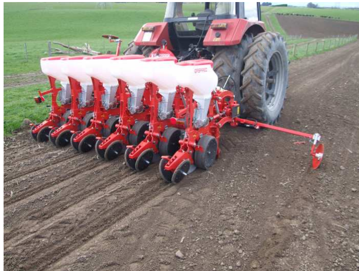
Kuva 2. Juurikaskasveille sopiva tarkkuuskylvökone. (Maschio [viitattu 8.3.2011].)
