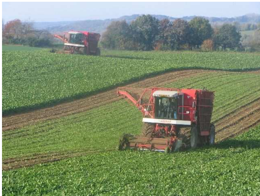
Kuva 7. Itse kulkeva juurikkaankorjuukone, jolla onnistuu naattien murskaaminen ja juurisadon korjuu yhdellä ajokerralla. (Vervaet [viitattu 4.12.2010]).
