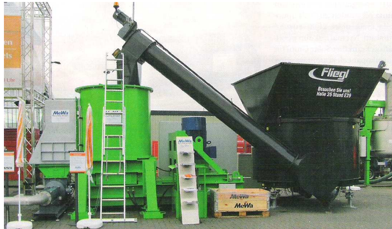
Kuva 9. Juurikkaan ilmatiiviin murskesäilönnän koneita. Oikealta lähtien murskain, pystysekoitin, murskaava sekoitin ja siiloon johtava pumppu. (Uotila 2010, 15.)
