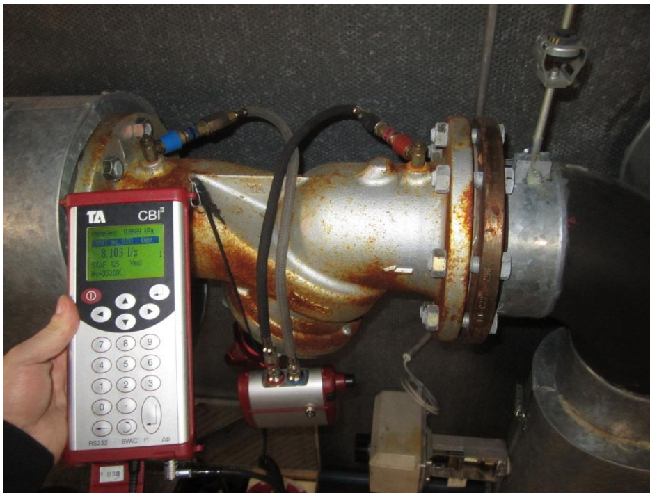
Kuva 20. Virtaaman mittaus TA:n CBI II-mittarilla.
