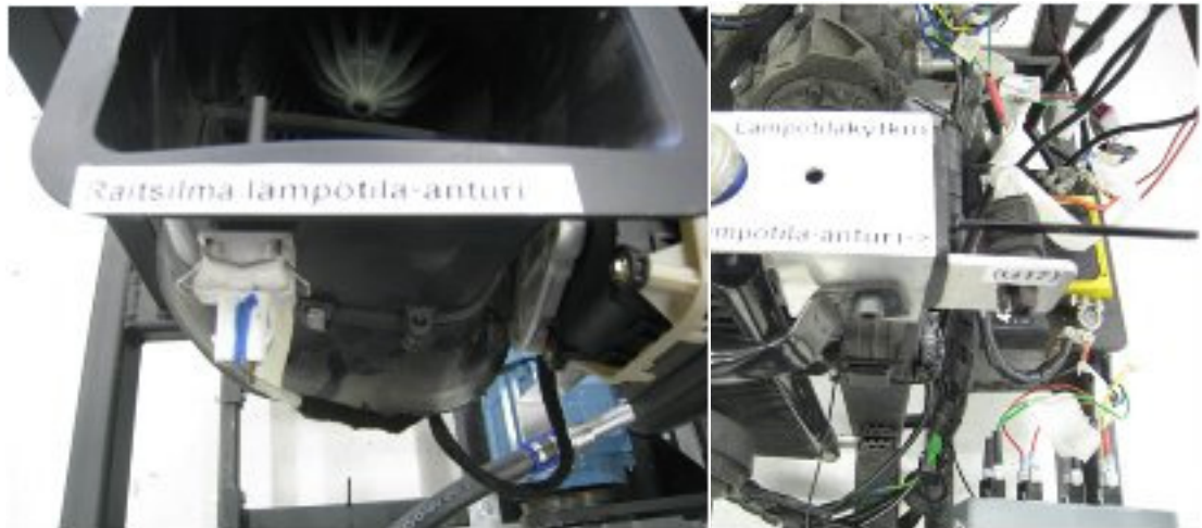
KUVA 27. Raitisilma- ja ulkolämpötila-anturi
