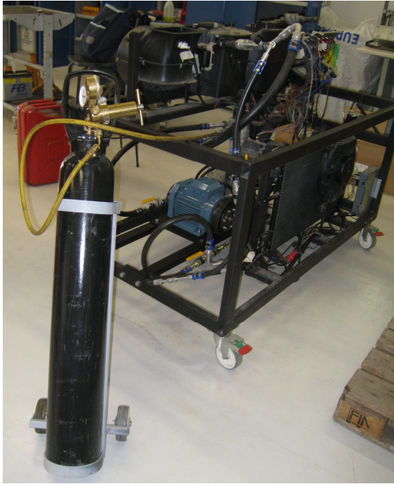
KUVA 58. Ilmastointisimulaattorin koeponnistus tyypellä
