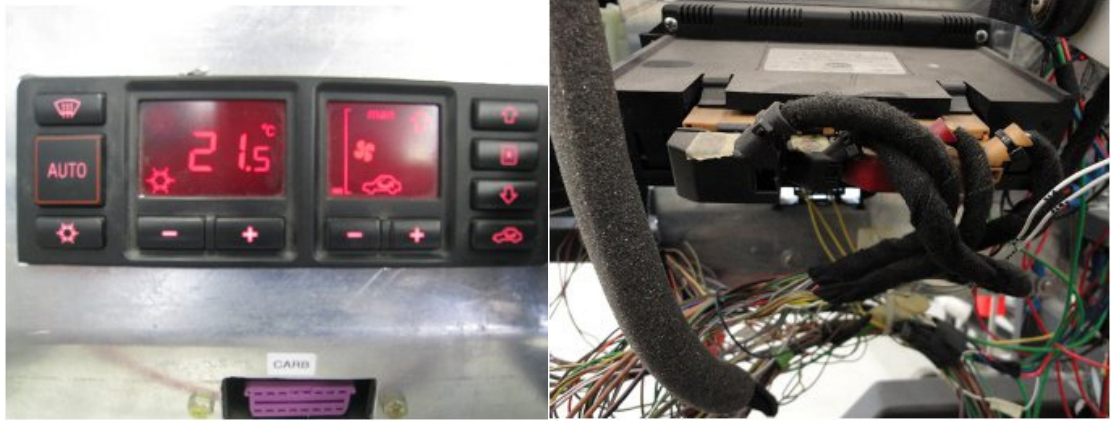
KUVA 25. Ilmastoinnin ohjainlaite edestä ja takaa
