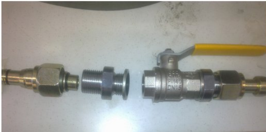
KUVA 56. Sulkuventtiilin liittäminen letkuliittimeen
