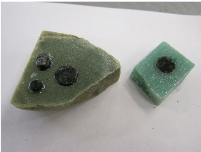
KUVA 26. Porausaihiot liimattu paikoilleen.
