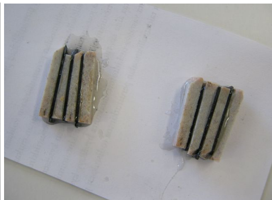
KUVA 15. Kivisiivut sahauksen jälkeen. KUVA 16. Kivisiivut liimauksessa.
