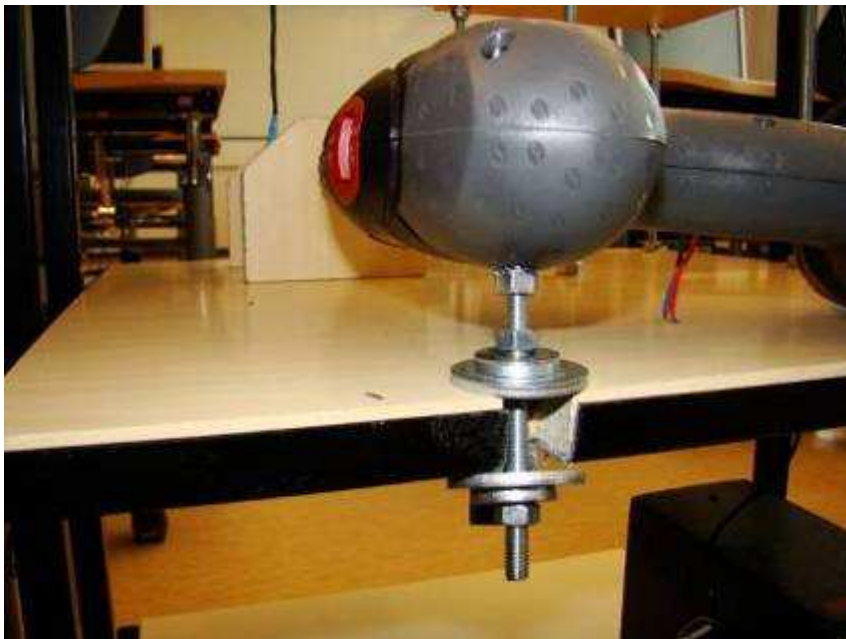
KUVA 24. Porakone kiinnitettynä testauspöytään
