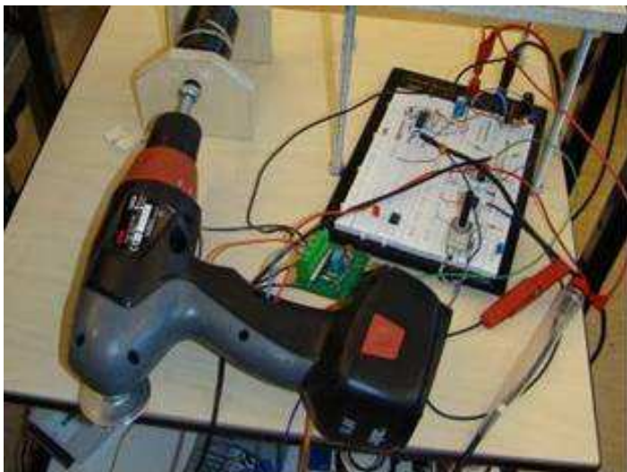
KUVA 28. Moottori kiinnitettynä testauspöytään. Pieni vihreä kortti sisältää virranmittauskytkennän.
