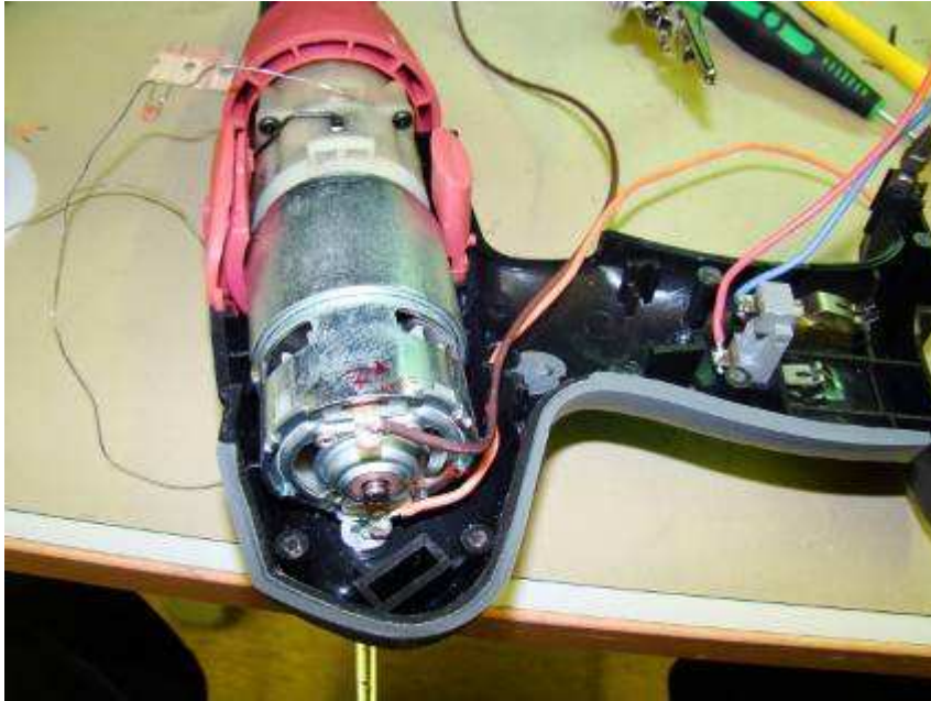
KUVA 23. Porakoneesta on poistettu ohjauselektronikka sekä käyttökytkin
