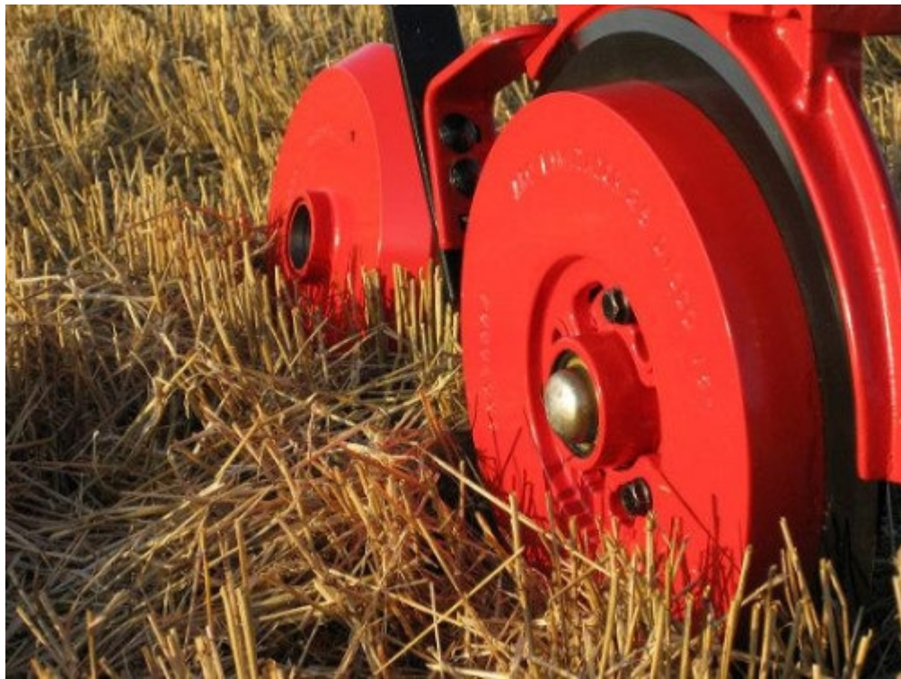
Kuva 7 Kaksoiskiekkovantaan sivuun on kiinnitetty syvyyden rajoittava leveä kiekko ( suomensuorakylvo.fi 2011b).
