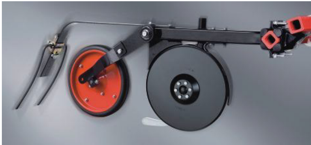
Kuva 21 Turbo Disc -vannasyksikkö, kaksoiskiekkon jäljessä näkyy kieli, joka painaa siemenet vaon pohjalle. Sen jälkeen painepyörä painaa vaon kiinni ja jälkiäes seuraa viimeisenä. (Pronto – esite 2009, 7.)
