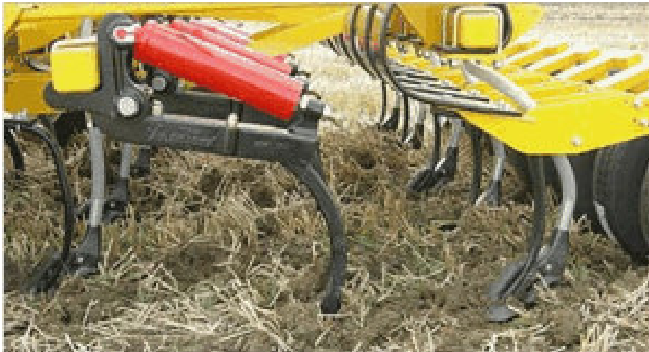
Kuva 8 Vetovantaat vasemmassa ja oikeassa rivissä sekä avauspiikit keskimäisessä rivissä (tak-sai.com 2011).
