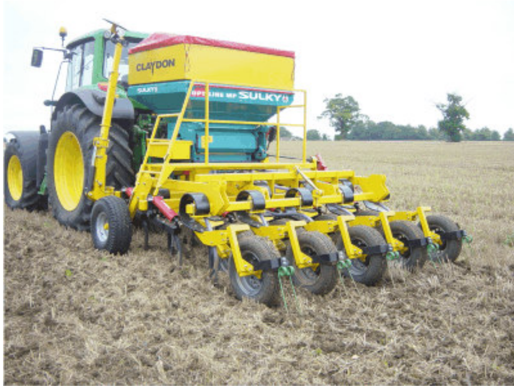
Kuva 23 Nostolaitesovitteinen Claydon SR ilman lannoitevarustusta(tak-sai.com 2011a).
