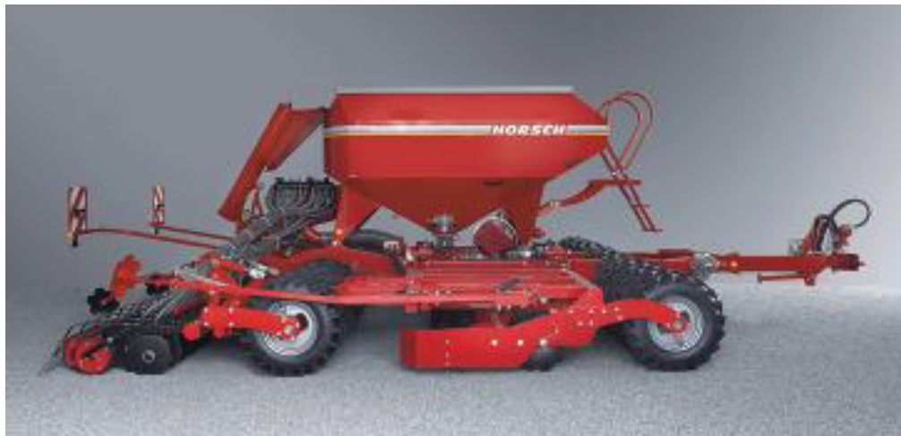
Kuva 20 Horsch Pronto DC, joka on varustettu täysleveällä etupakkerilla (Pronto – esite 2009, 5).
