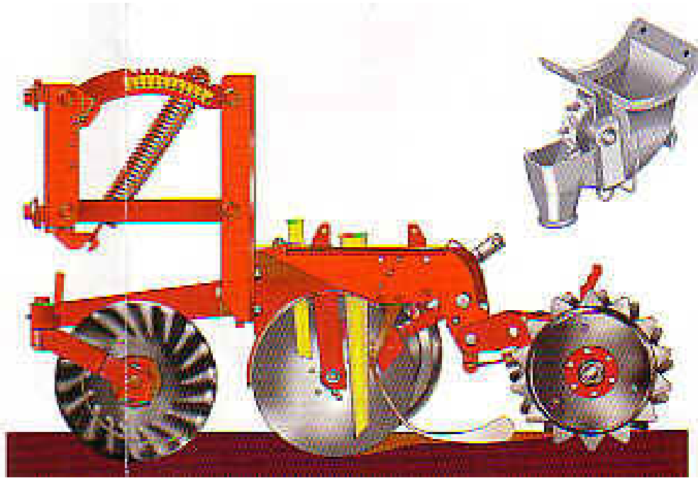
Kuva 46 Jousikuormitus vaikuttaa koko vannasyksikön painatukseen. Kaksoiskiekkovantaan (keskellä poikkileikkauskuva) sisälle katsottaessa näkyy keltaisena lannoite- ja siemenputki. (agencykoppinen.net 2011a 2011.)
