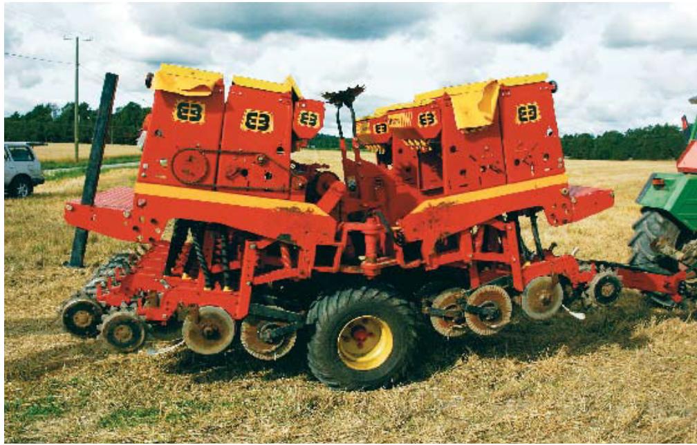
Kuva 45 Bertini 22000 kuljetusasennossa, sivulohkot etenkäännettyinä (Oristo & Oristo 2006a, 62).
