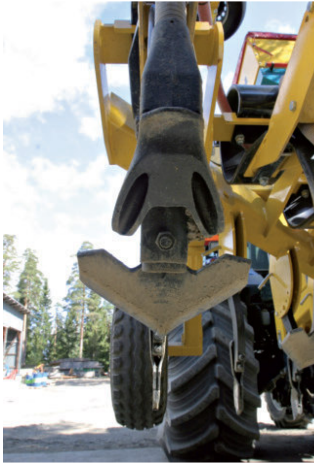
Kuva 24 Hanhenjalkatyyppinen nauhakylvävä vetovannas. Kuvassa näkyy myös avauspiikkejä (Mustonen 2007, 43).
