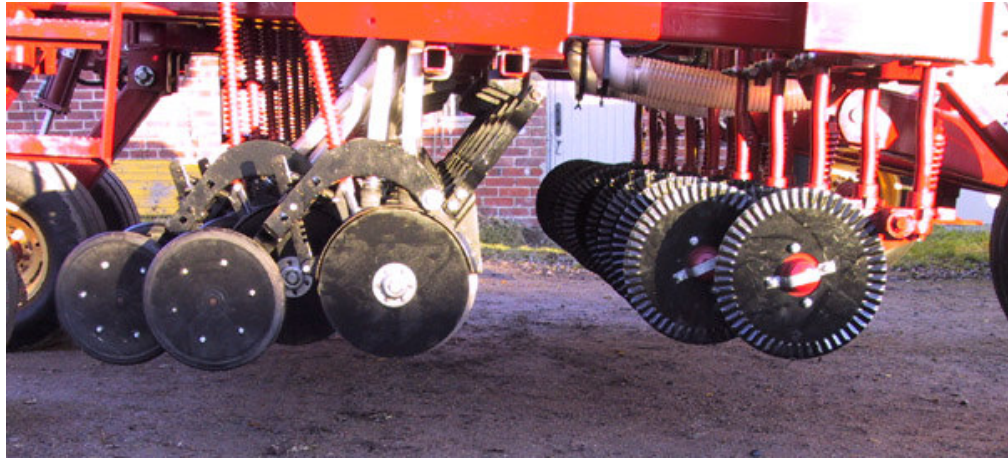
Kuva 1 Oikealla avauskiekkoo, joka tekee uran vain kylvörivin kohdalle (pala.net 2011)
