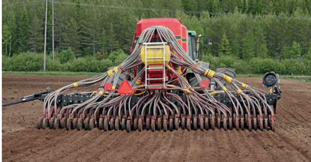
Kuva 51 VM 6000 DS, koneessa myös erillinen piensiemensäiliö (keltainen) (Knaapi 2009, 21).
