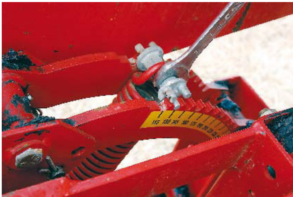
Kuva 47 Vannasyksikön painatusvoimaa voidaan säätää avaimella siirtämällä joustahammaskaarella (Oristo & Oristo 2006, 64.)
