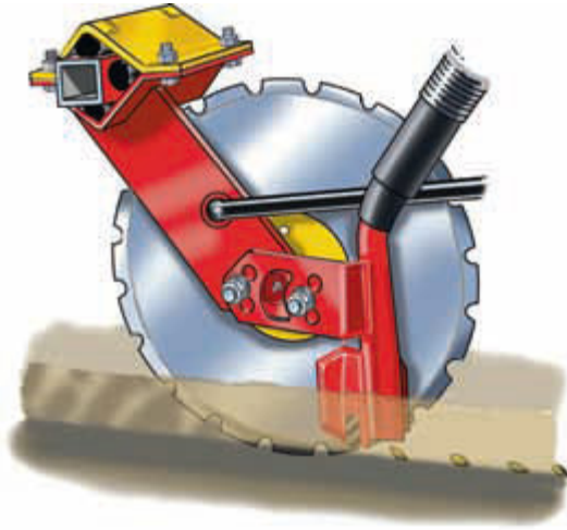
Kuva 16 Kylvövannas jossa näkyy suppilo, reaktiotanko, ja kumipatukkajousitus, joka mahdollistaa kivien ja muiden epätasaisuuksien ylitykset (Rapid – esite 2010).
