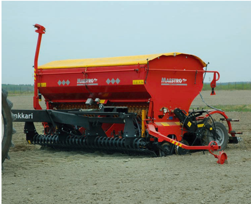
Kuva 28 Junkkari Maestro Plus, kuvassa näkyy mm. yksirivinen etulata (Maestro Plus – esite 2010, 3).
