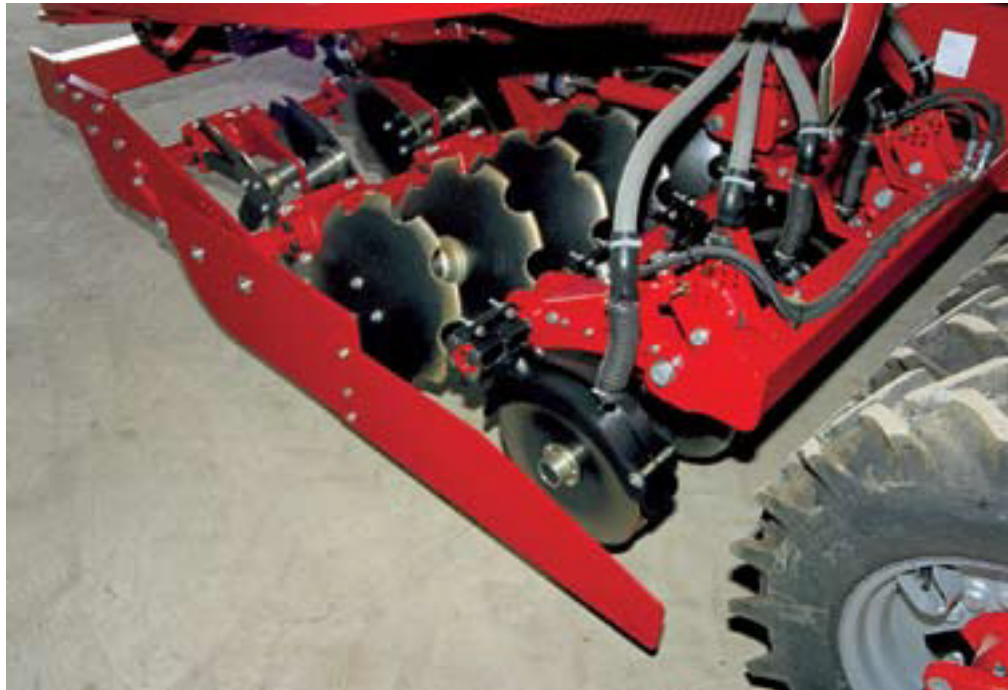
Kuva 2 Kylvövannasrivistön edessä kaksirivinen etumuokkain (Härkönen 2008).
