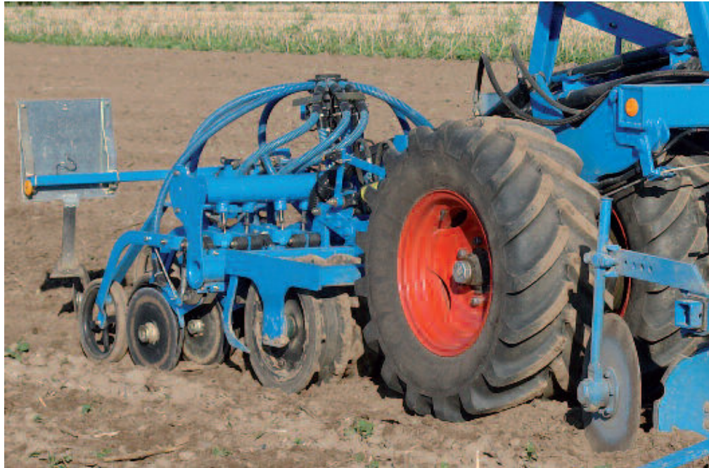
Kuva 40 Jyräpyörästö, trapetsisijrä, kaksoiskiekkovannas ja tiivistyspyörä (Solitair – esite suomi 2008, 9).
