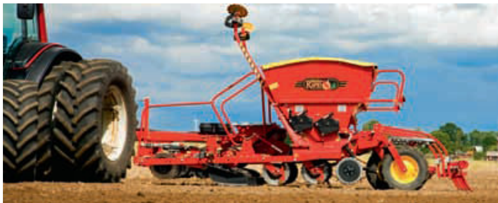
Kuva 14 Väderstad Rapid varustettuna System Disc – esimuokkaimella (Rapid – esite 2010).
