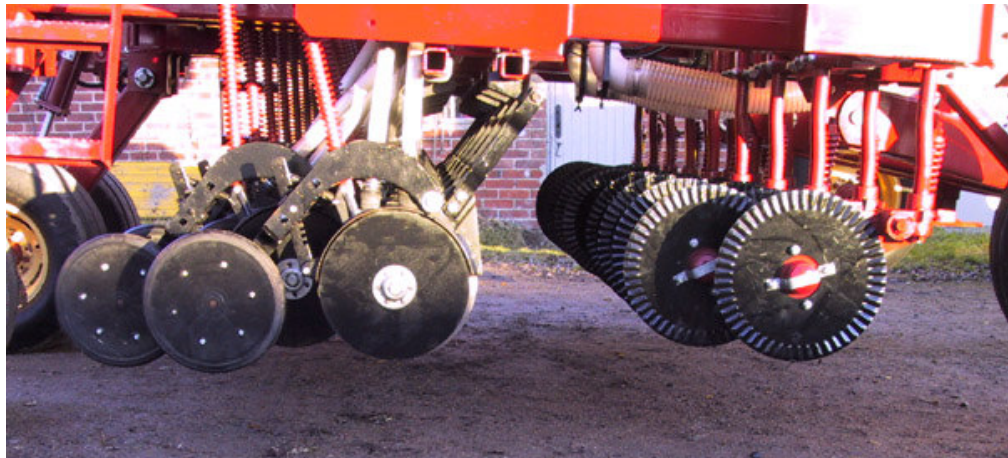
Kuva 43 Kuvassa näkyvät mm. etuleikkurit, kaksoiskiekkovantaat ja kumipinoitetut tiivistyspyörät (palola.net 2011).
