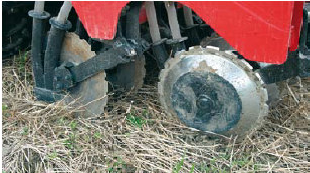
Kuva 29 Kiilajyrävannas, lannoite ja siemen samaan vantaaseen (Varpio & Härkönen 2006, 10).
