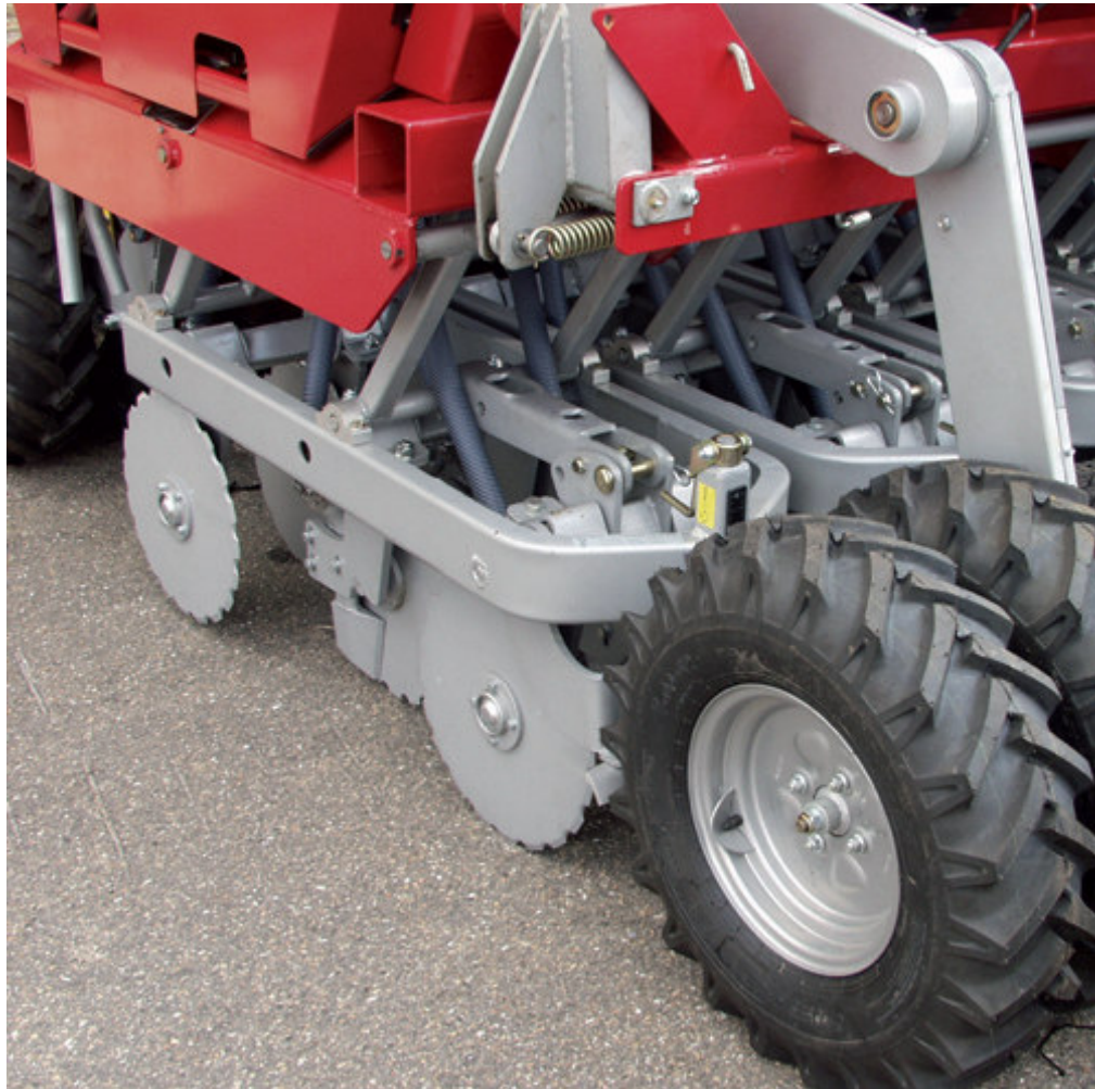
Kuva 13 Vannasyksikkö ja sen edessä oleva syvyydensäätöpyöräpari. Kuvassa näkyy myös säätöveivi. (Flexidrill_FIN.pdf 2007)
