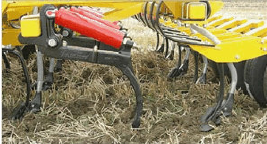
Kuva 25 Claydon SR, etupiikit automaattilaukaisimilla ja vetovantaita kahdessa rivissä (tak-sai.com 2011).
