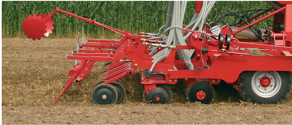
Kuva 38 Oikealta alkaen jyräpyörästö, kaksi riviä kylvövantaita, tiivistyspyörä ja jälkihara. (Kverneland – esite PDF, 7).
