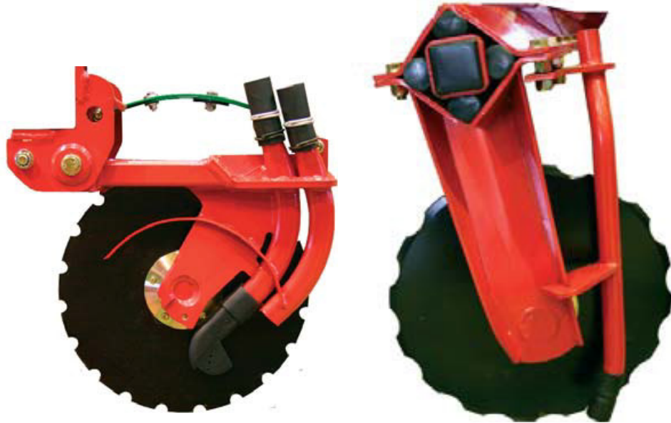
Kuva 37 Vasemmalla kylvövannas ilman muovikiekkoa, oikealla etumuokkainkierokko lannoitevarustuksella (Kverneland – esite PDF, 8).
