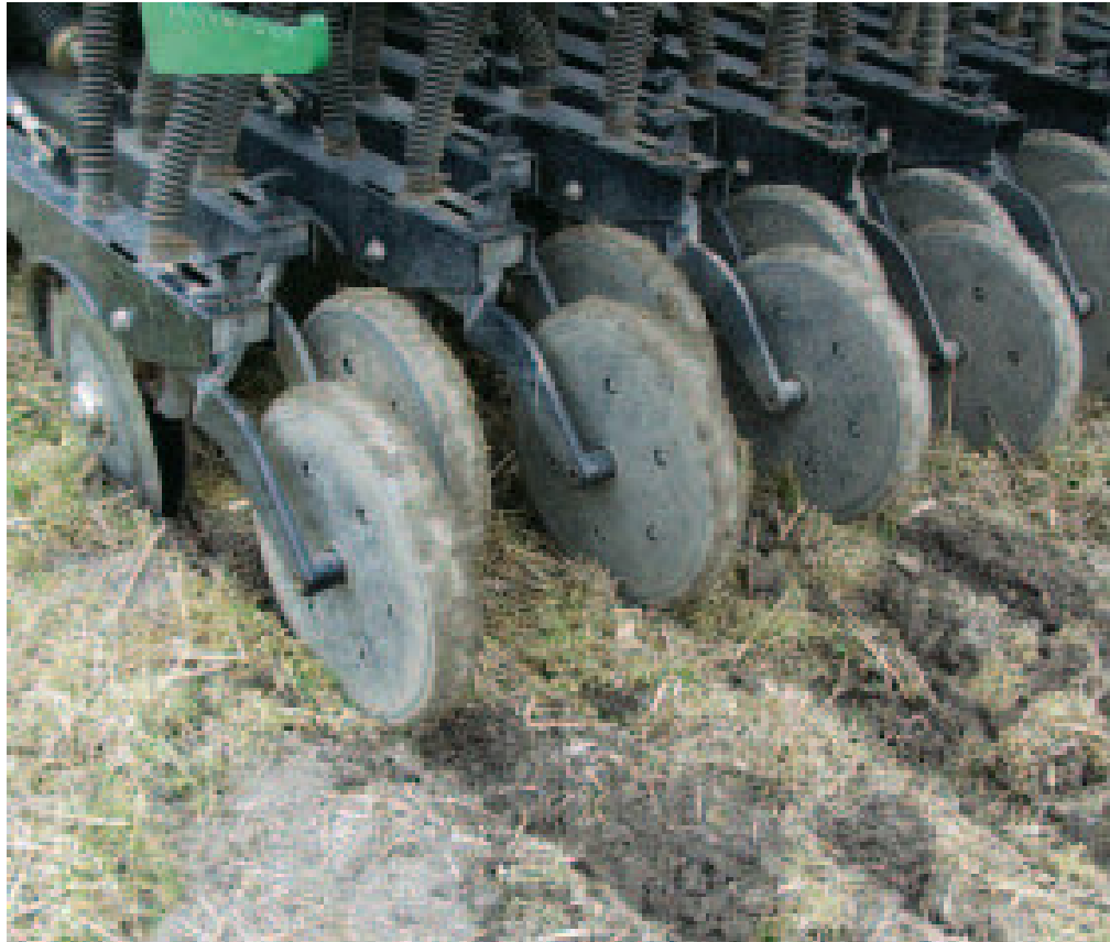
Kuva 6 Kaksoiskiekkovantaan takana kulkee vannaskohtainen syvyydensäätöpyörä, joka myös sulkee ja tiivistää kylvövaon (Oristo & Oristo 2004, 7).
