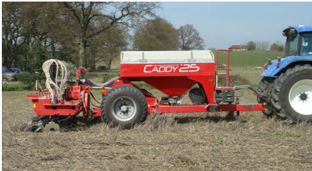
Kuva 42 Krause Caddy ja kylvöyksikkö Heavy Residue -vantailla, jotka selviytyvät runsaasta kasvinjättemäärästä (palola.net 2011).
