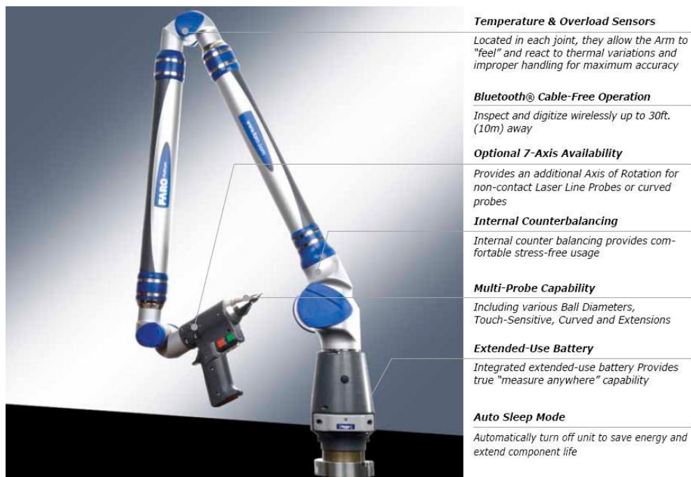
Kuva 9. FARO Platinum 7- akselinen nivelvarsimittauskone /4/
