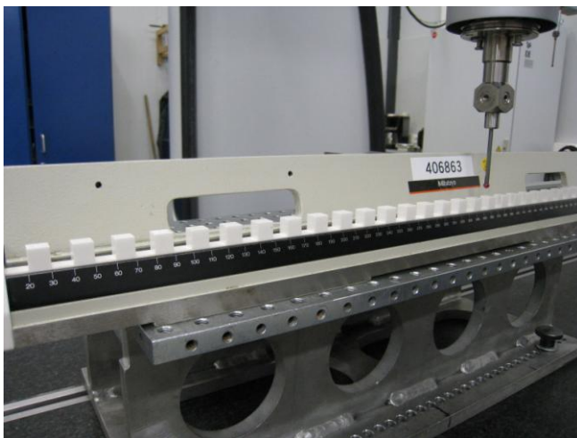
Kuva 13. Porrasmittapalojen mittaus koordinaattimittauskoneella LEITZ
