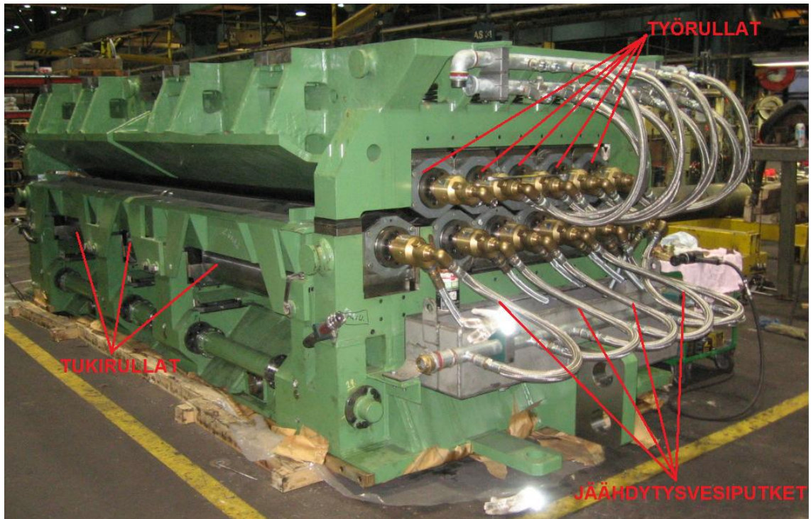
Kuva 17 Kuumaoikaisukone 1 huollettuna. Kuvassa nähtävissä työrullien jäähdytysvesiputket
