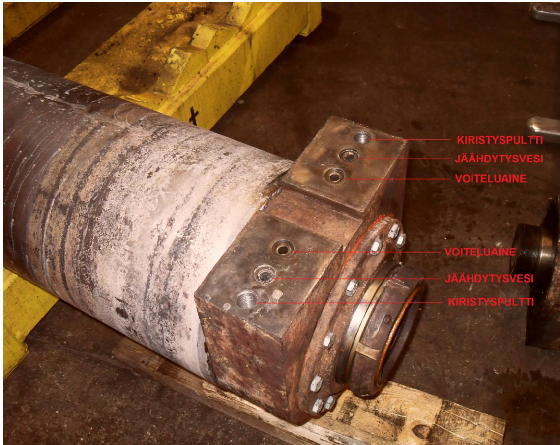
Kuva 6 Vaakasegmentin laakeripesän rasvan- ja jäähdytysveden sisääntulo
