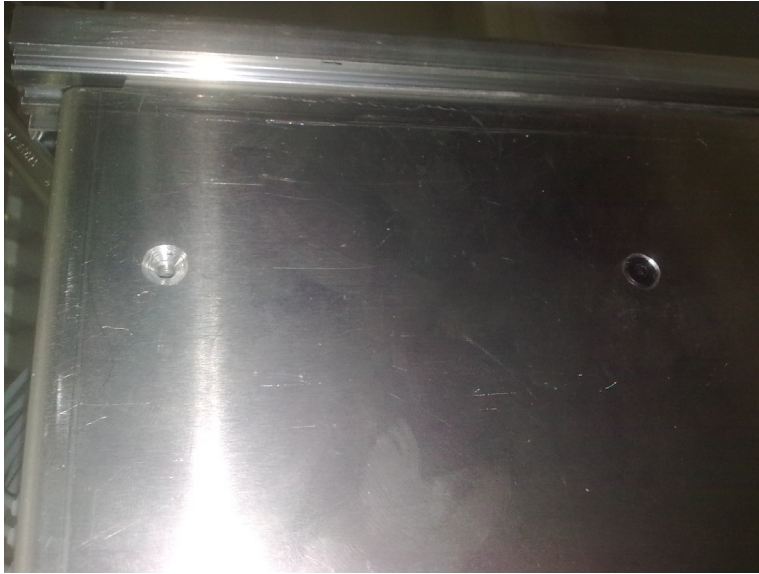
KUVA 7. Pohjalevyn kiinnitysreikien senkkaus(Kuva: Erno Toivonen 2011)
