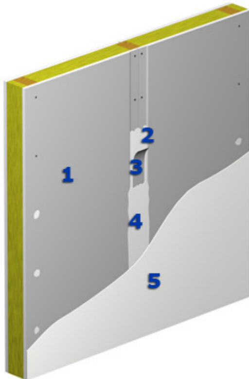
Kuva 11. Tasoitetun kipsilevyseinän rakenne kuivissa tiloissa [8].
