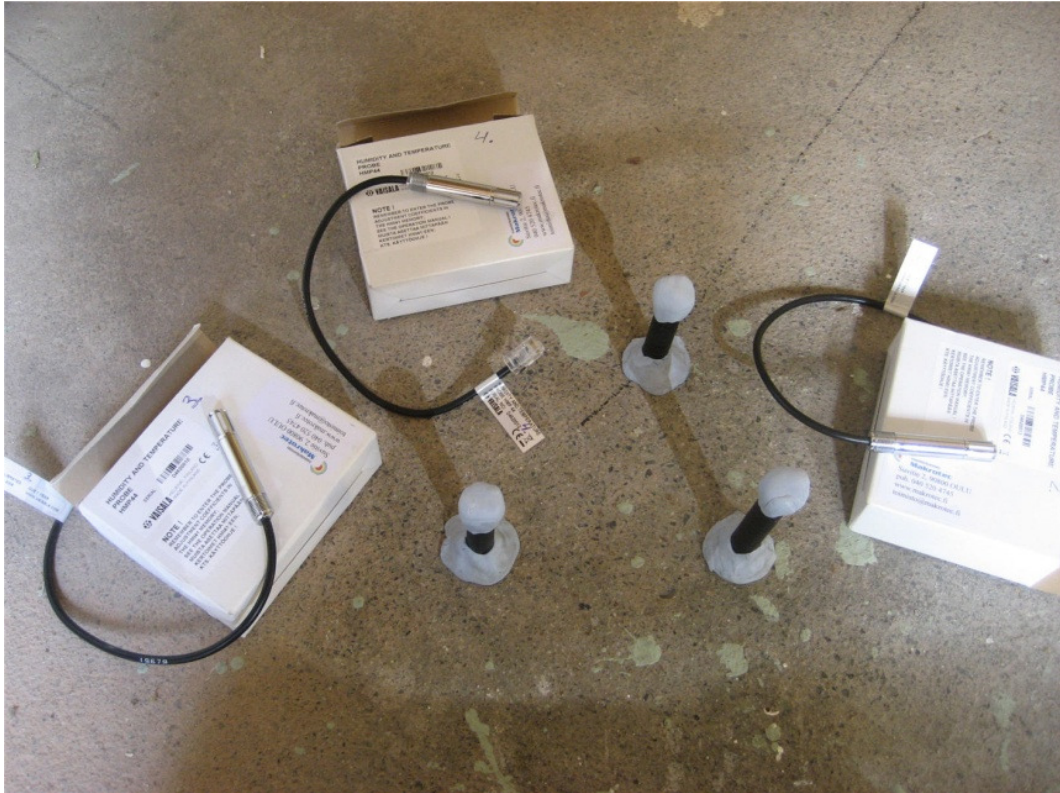
Kuva 17 Kosteusmittausreikiin asennetut putket mittausta varten[10].
