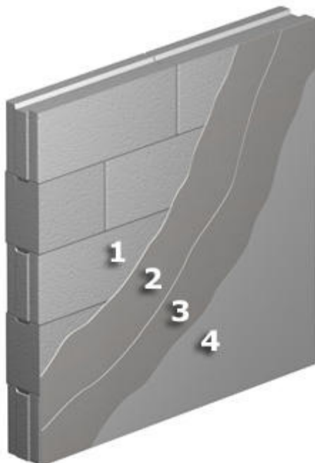
Kuva 12. Tasoitetun harkkoseinän rakenne märkätiloissa[8].
