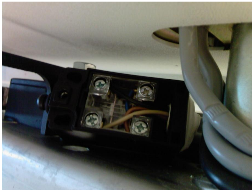
Kuva D. Kuvassa on Deltan lavan takana sijaitseva mikrokytkimen kansi avatuna. Vasemmalla näkyy suuntaa ilmaiseva muoviholkki.
