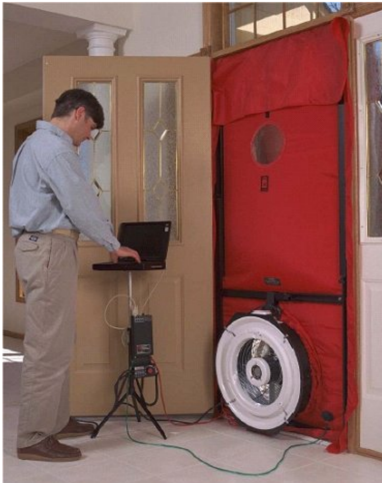
Kuva 13. Kuvia aiheesta ilmantiiveyden mittaus.
