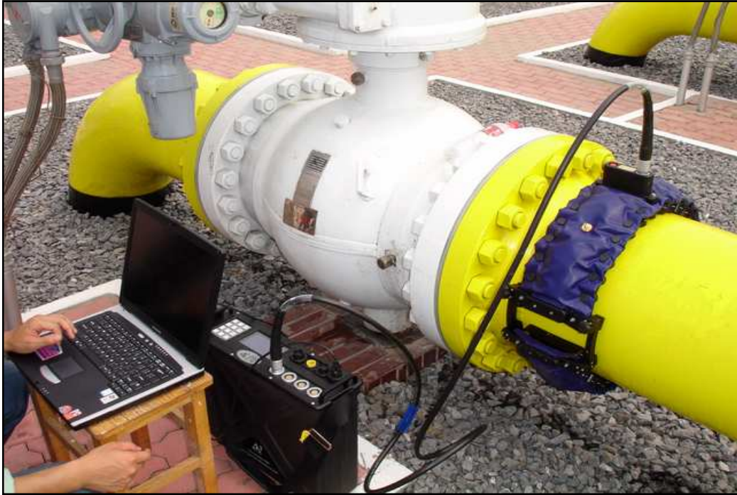
Kuva 7. GuidedWave-laitteisto ilmatäytteisellä lähetinrenkaalla [4].
