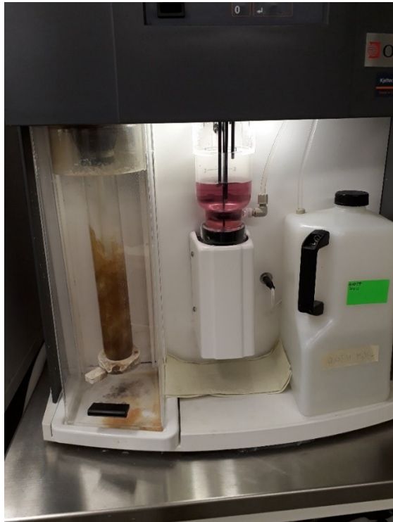
Kuva 7. Poisteiden ammoniumtyppipitoisuuden mittaus Kjeltec-analysaattorilla.
