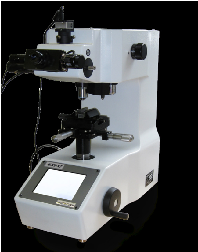
KUVA 4. Kovuusmittauksessa käytettävä laitteisto. Kuva Savonia-amk
