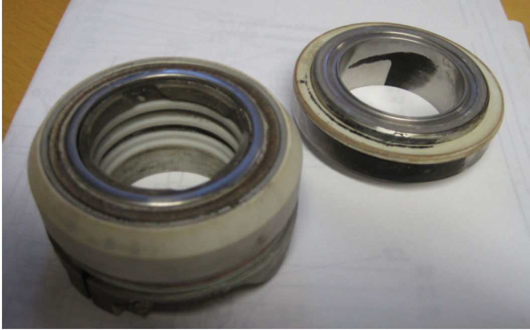
KUVA 21. Tiivisterenkaat koeajon päättyessä. Kuva Erkki Sallinen
