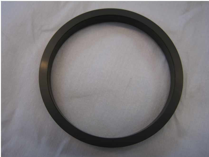
KUVA 6. Valokuva on pinnoitetusta tiivisterenkaasta. Kuva Erkki Sallinen
