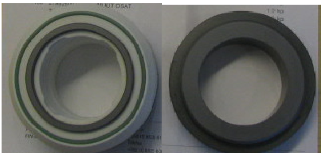
KUVA 20. Tiivisterenkaat koeajon alkaessa. Kuva Erkki Sallinen
