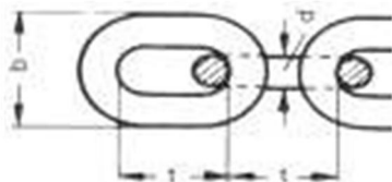
Kuva 16. Kettinki DIN 766 päämitat [17]
