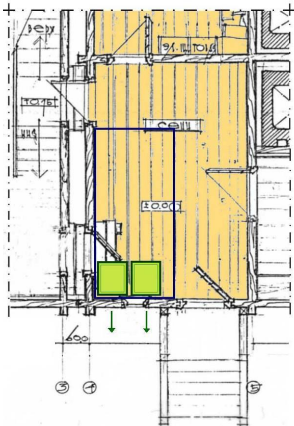
Kuvio 9. Siirrettävien kompostisäiliöiden asennuspaikat on merkitty eteisen pohjapiirroksen vihreillä suorakulmioilla.
