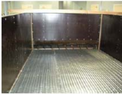
KUVA 6. Mekrijärven tutkimusaseman kuivurin suomupohjalevy (Koepelletöinti – Koepelletöintikokeet. Mekrijärven koepelletöintilaitteisto. Infokortti 13. 2010)
