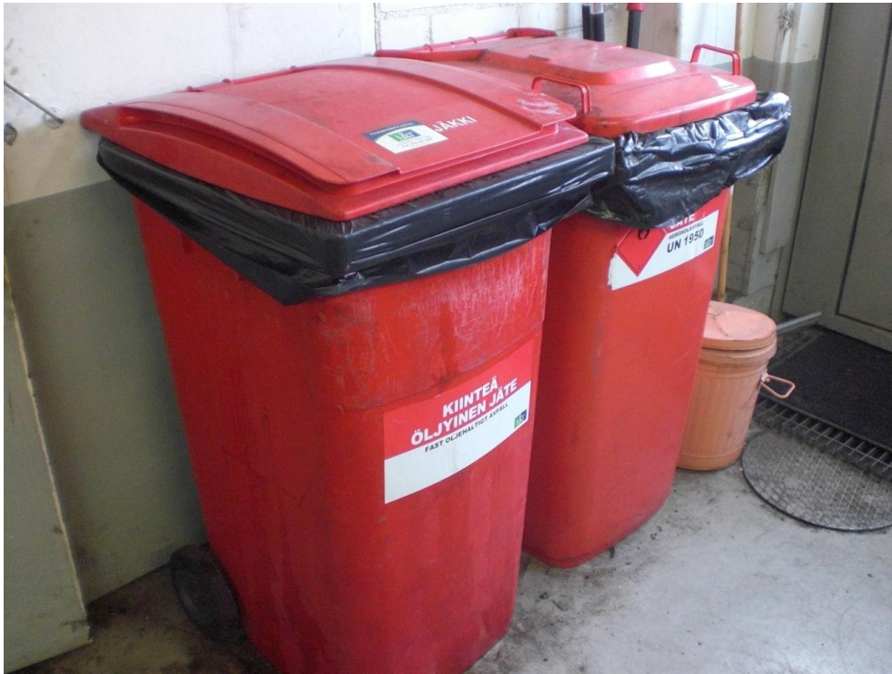
Kuva 2. Kiinteän öljyisen jätteen ja aerosolijätteen keräilyastiat.
