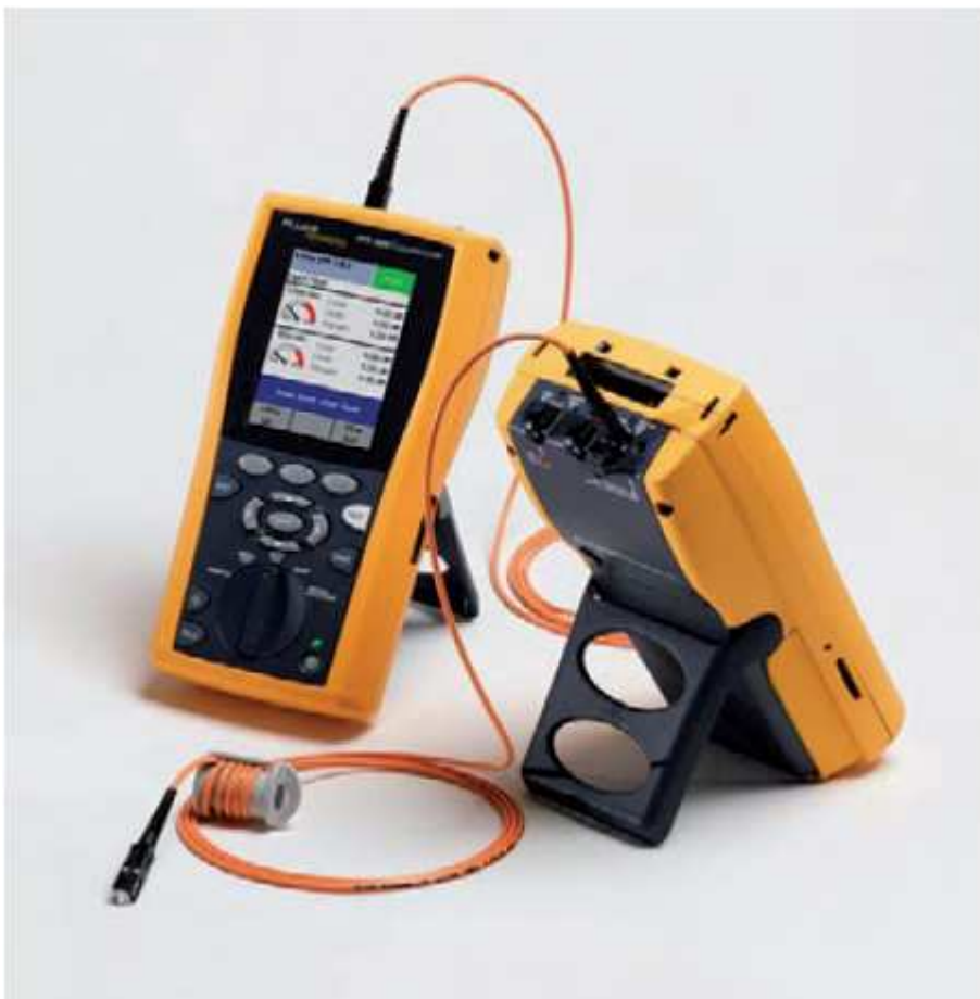
KUVIO 5. Esimerkki parikaapelitestauslaitteesta. (ST-KÄSIKIRJA 16, 2008, 342)
