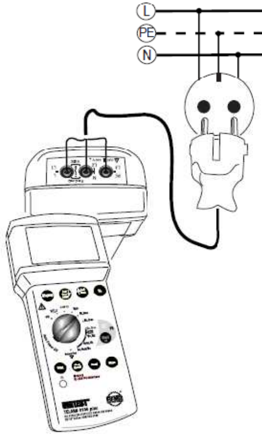
KUVIO 14. Oikosulkuvirran ja silmukkaimpedanssin mittaus.
