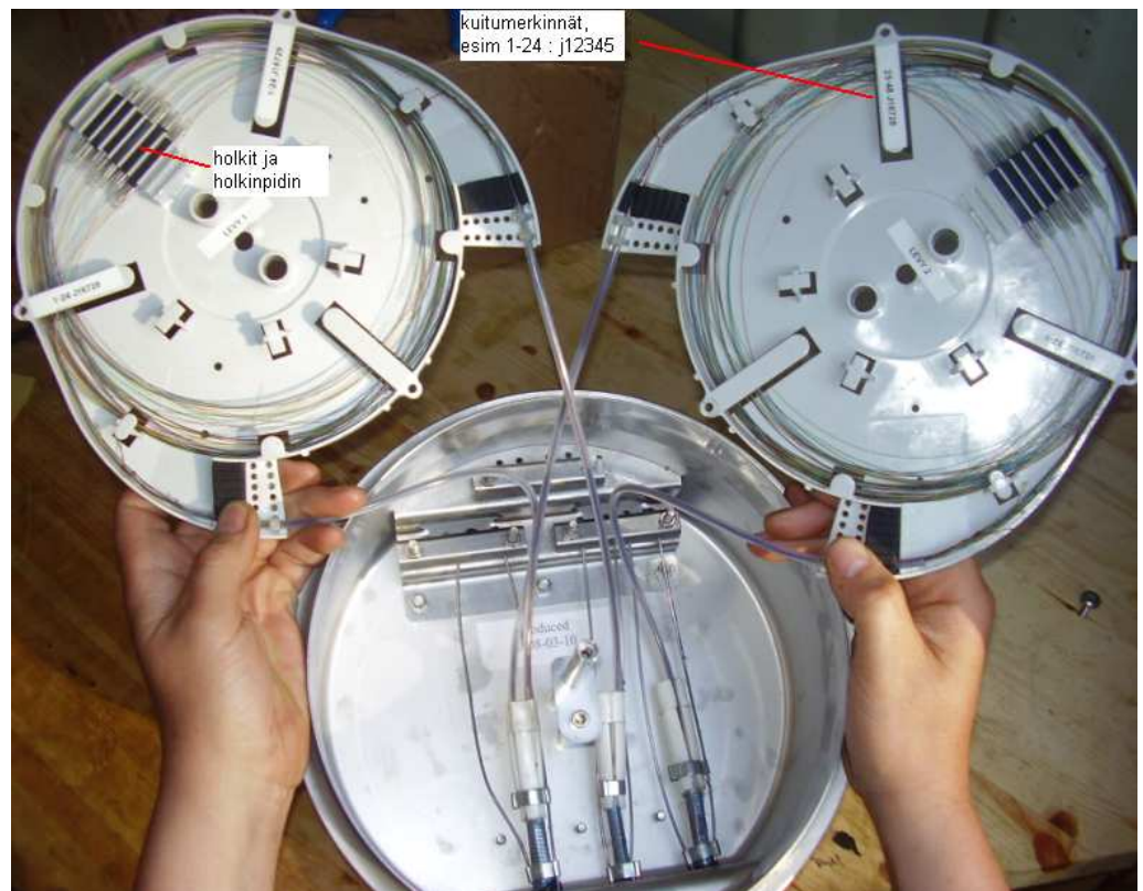
Kuva 23. Tykoflex-jatkoskotelo avattuna, jatkoslevyt näkyvillä
