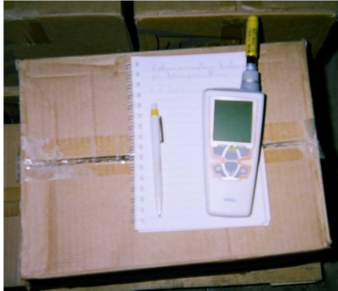
Kuva 27. Käsimittari tasaantumassa kosteusvaurioisessa kellarissa. JV 2011
