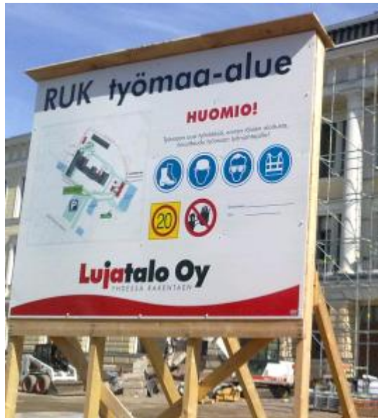
KUVIO 4. Tällä työmaalla käytettävät henkilösuojaimet (Lujatalo Oy)
