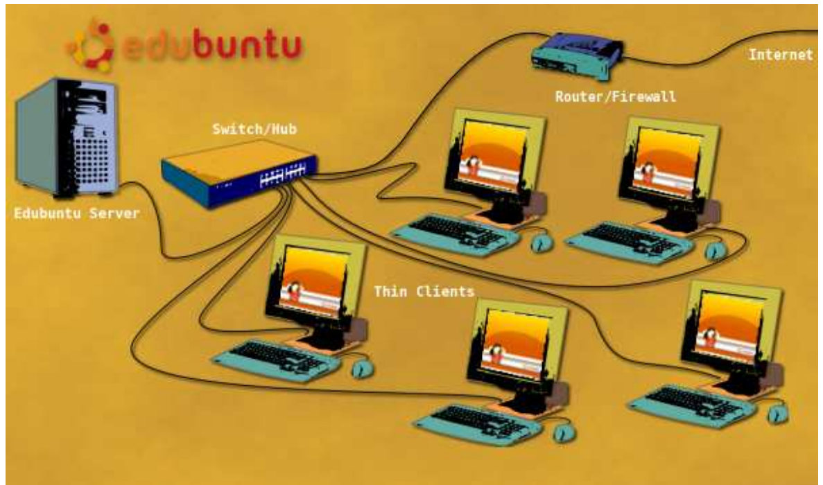
Kuva 4. Yhdellä verkkokortilla varustetun LTSP-palvelimen kytkentä /9/
