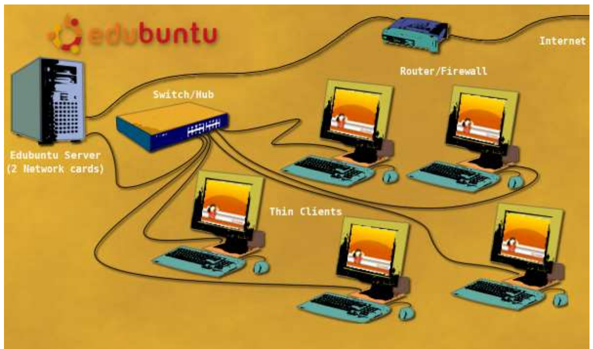
Kuva 5. Kahdella verkkokortilla varustetun LTSP-palvelimen kytkentä /9/
