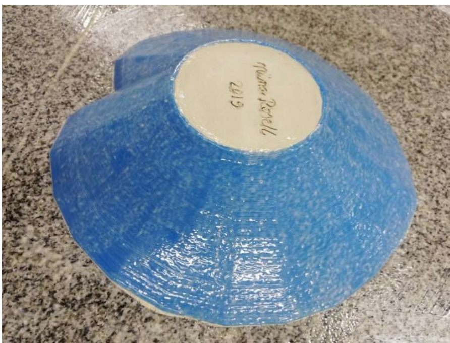
Kuva 40. Lautasen 3D-tulostettu malline, jossa erotusaine pinnassa.
