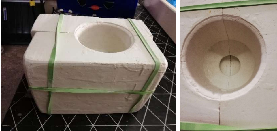
Kuva 50. Kupin kaksiosainen muotti. Tässä ensimmäisiä testivaluja - sahasin molemmat kipsimuotinpuoliskot saman kokoisiksi myöhemmin.
