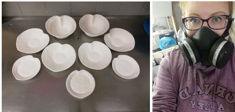
Kuva 58. Raakapollettujen esineiden hiomista.
