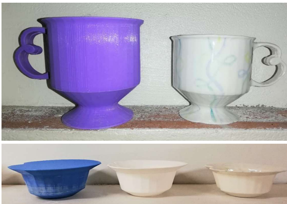
Kuva 65. Kupin ja kulhon 3D-tulostettu malline ja valmis lasitettu esine. Kulhosta myös raakapoltettu runko.
