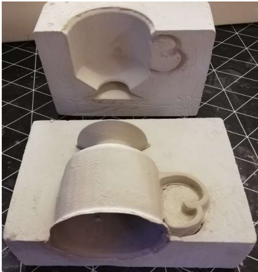
Kuva 52. Kupin valumuotinpuolikkaiden irrotus.
