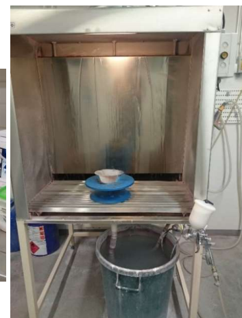
Kuva 62. Lasitin esineet paineilmaruiskulla lasituskaapissa.
