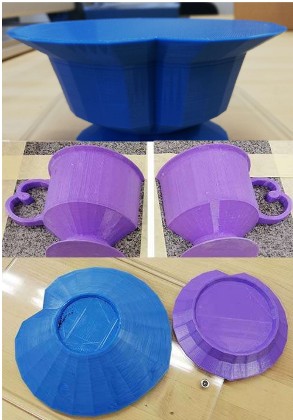
Kuva 37. Kuvassa kaikki 3D-tulostetut mallineet: kulho, kaksi kupinpuolikasta ja kaksi erikokoista lautasta. Kulho ja isompi lautanen tulostettiin 1 mm suuttimella, kupinpuolikkaat ja pienen lautaseen malline 0,4 mm kokoisella suuttimella.
