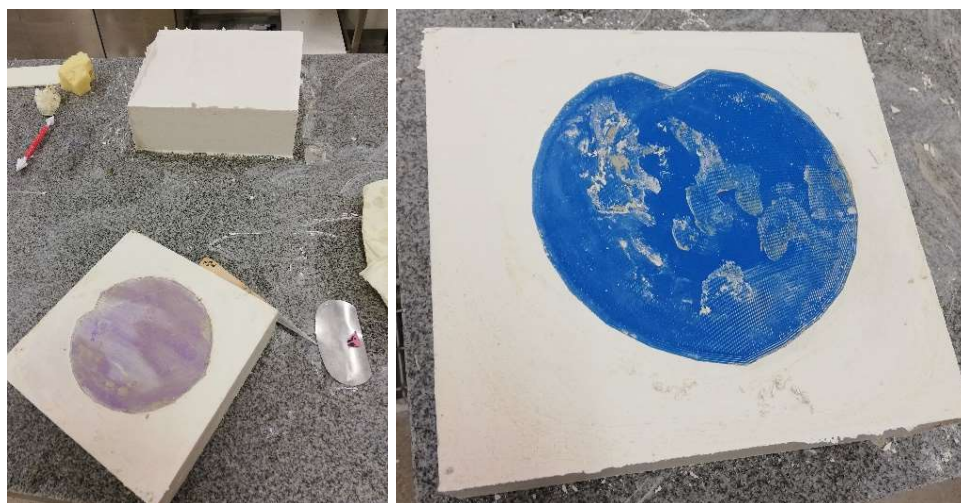
Kuva 43. Lautasten kipsimuotit ennen irrotusta.
