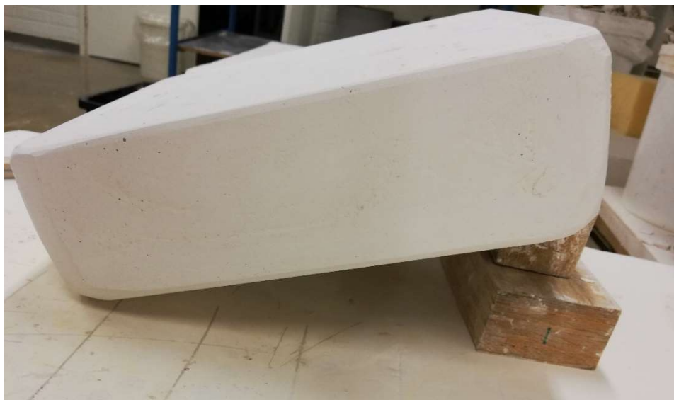
Kuva 49. Lautasen valu kuivumassa kipsimuotissa.
