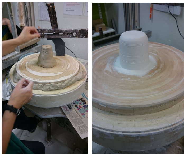
Kuva 45. Mallineen valmistusta kipsidreijalla
