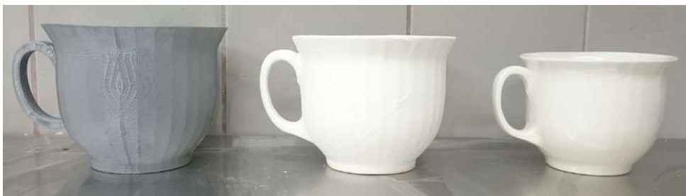
Kuva 1. Kevään 2018 kuppiprojekti. Kuvassa vasemmalla 3D-tulostettu malline, keskellä raakapoltettu kuppi ja oikealla kuppi lasituspoltettuna.
