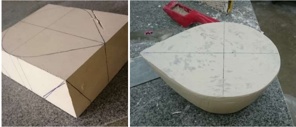
Kuva 5. Keramiikan kipsityöskentelyssä käytetään perinteisesti kipsistä valmistettua mallinetta. Kuvissa vasemmalla aihio kipsimallineesta, oikealla käsityökaluja käyttäen muotoiltu kipsimalline.
