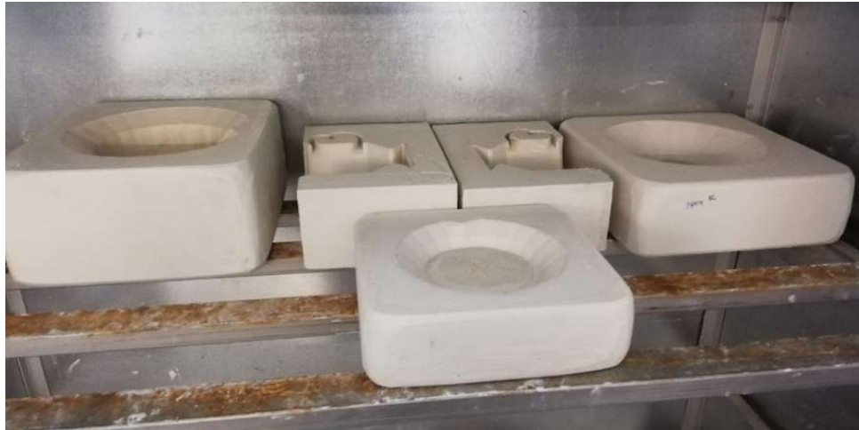
Kuva 46. Kaikki kipsimuotit kuivumassa.
