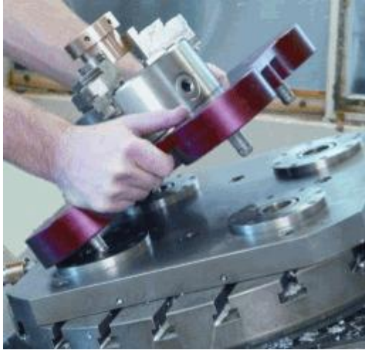
KUVIO 4. Koneistuskiinnitin paikoittuu nollapistetapeilla nollapistekiinnitinlevyyn
