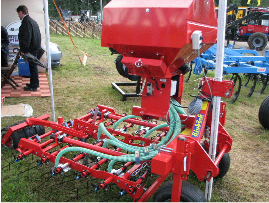
KUVIO 6. Pneumaattisella kylvölaitteella varustettu nurmiäes
