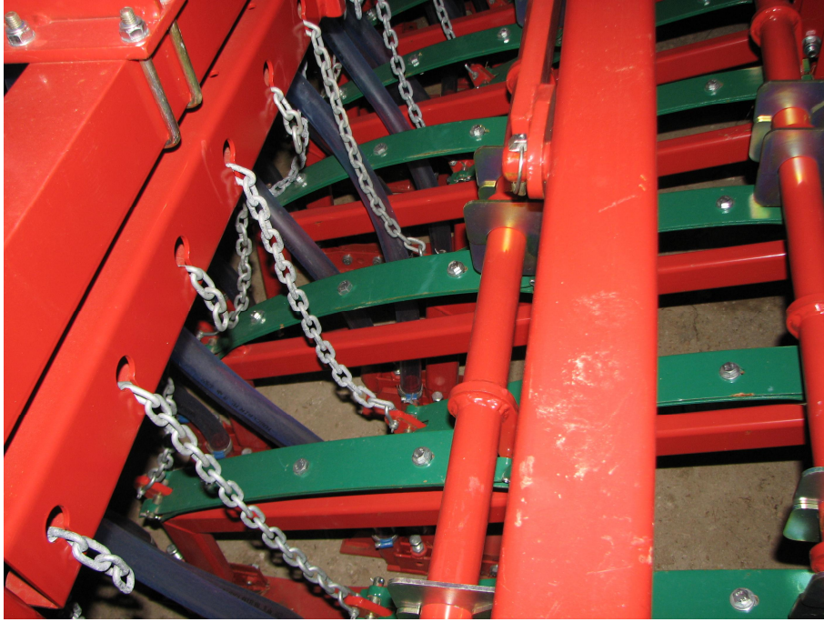
KUVIO 9. Veitsivantaan jousipainotus järjestelmä
