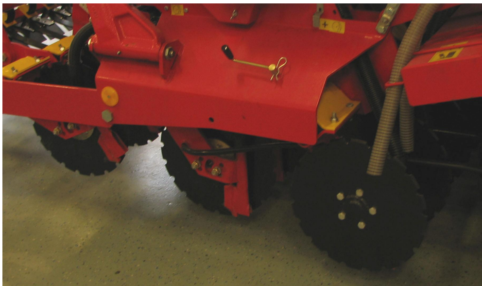
KUVIO 13. Erilliset kiekkovantaat lannoitteelle, sekä viljan- ja heinäsiemenelle
