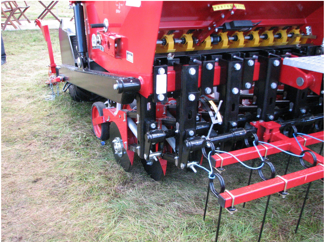
KUVIO 12. Edessä vannaspainotusjärjestelmä ja jousihara. Kaksoiskiekkovannas, tukipyörä ja jyräpyörästä kuvan takaosassa.
