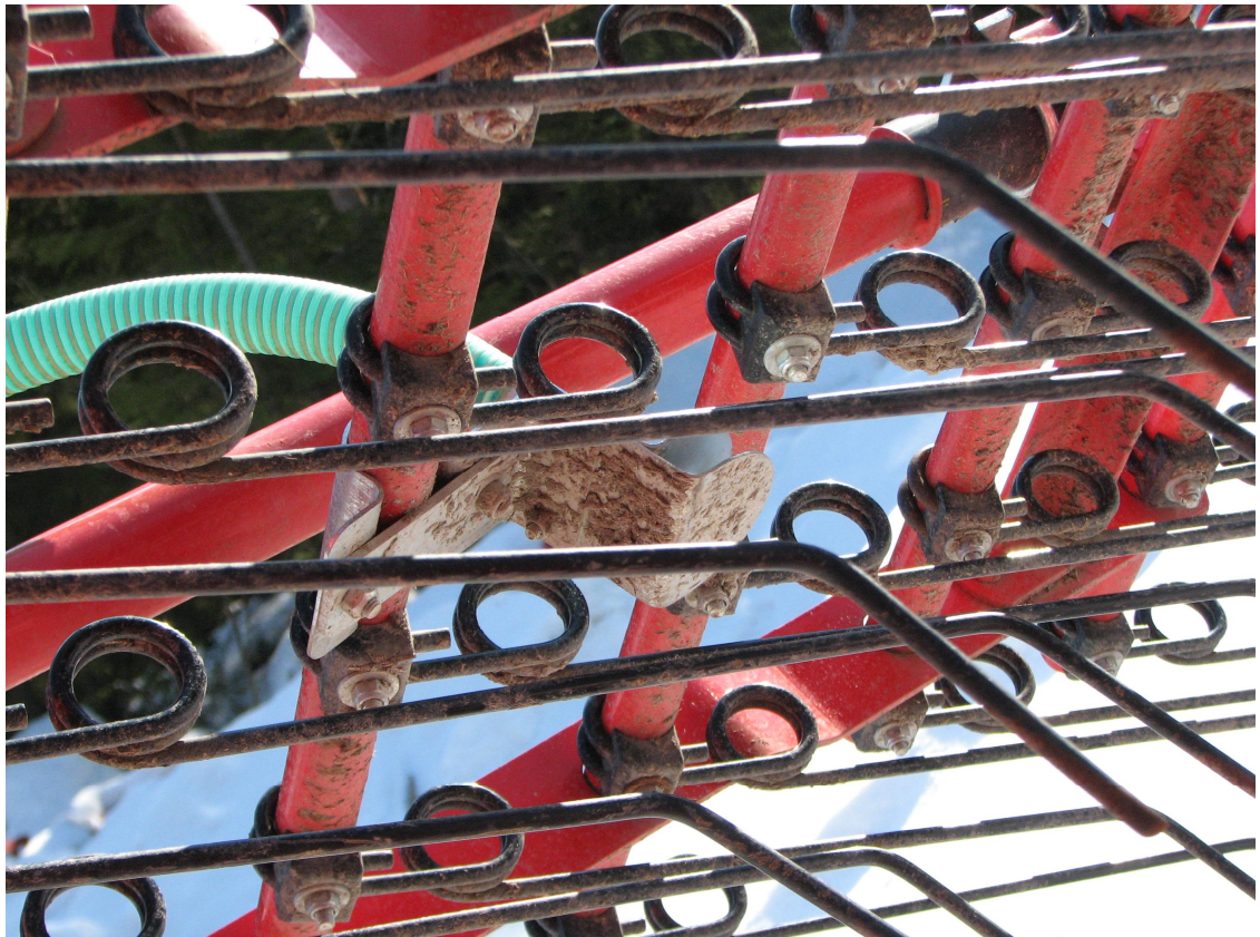
KUVIO 7. Nurmiäkeen piikkirivistö ja pneumaattisen kylvölaitteen kylvösiemenen levitin.
