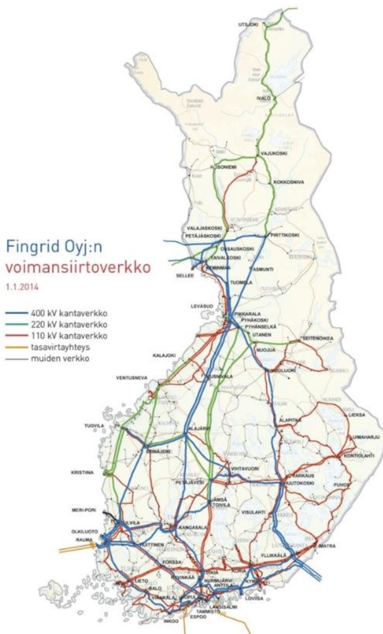
Kuva 3. Suomen kantaverkko. (Energiateollisuus – Sähköverkkojen rakenne)
