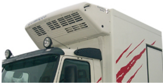
KUVA 6. Lämmösäätölaitteen sijainti kuormatilassa (5)
