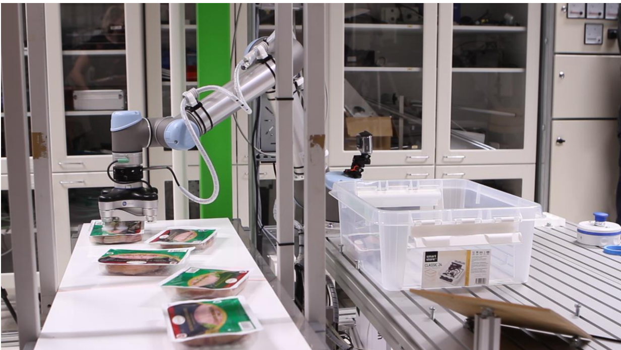
Kuva 4. 3D-kamera ohjaa yhteistyörobottia kuljettimella kulkevien leikkelepakkausten poimimisessa ja laatikoihin pakkaamisessa.
