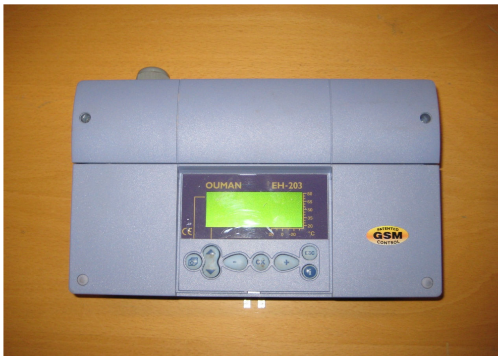
KUVA 9. Vanha järjestelmä koostui Ouman –merkkisistä yksikkösäätimistä
