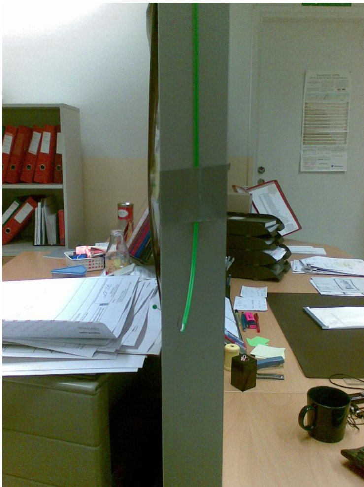
Kuva 5.5. Termopari paikallaan työpisteiden välissä.
