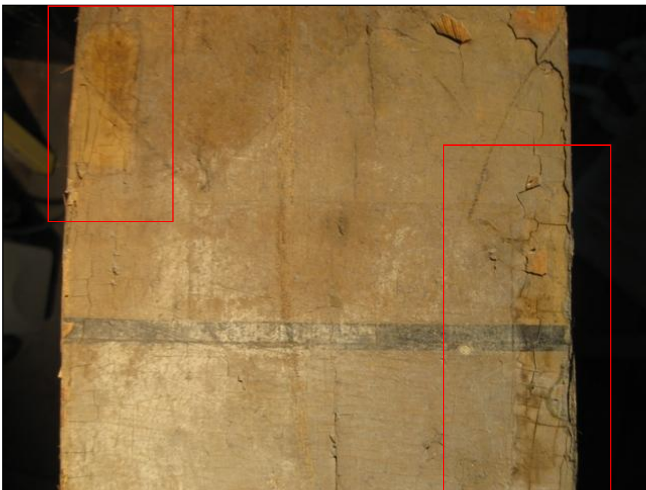
Kuva 23. Vasemmalla triammoniumsitraatilla, oikealla myös kuvassa 21 näkyvä syljellä ja saippuavedellä puhdistettu alue
