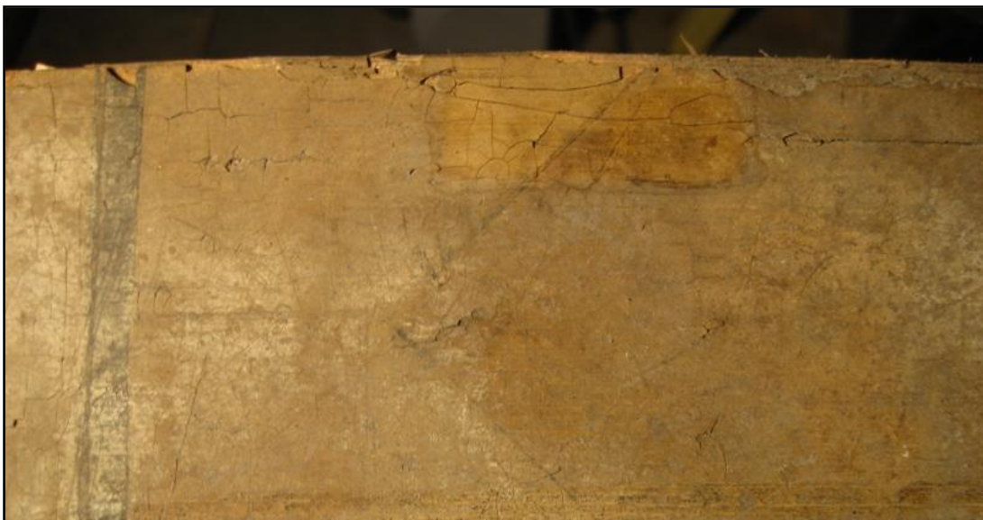
Kuva 22. Triammoniumsitraatilla puhdistettu alue
