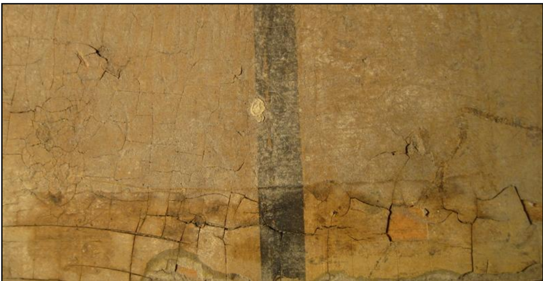
Kuva 21. Vasemmalla syljellä, oikealla saippualliuoksella puhdistettu alue
